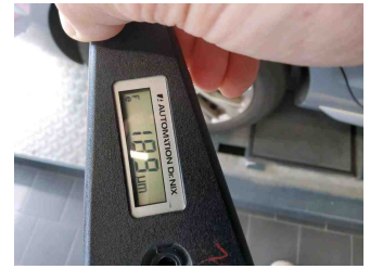
Lackstärke Seitenwand hinten rechts
