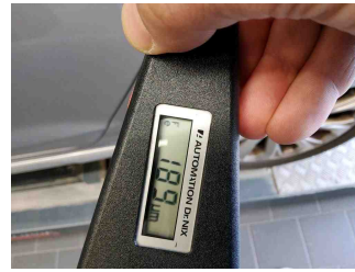
Lackstärke Seitenwand hinten links
