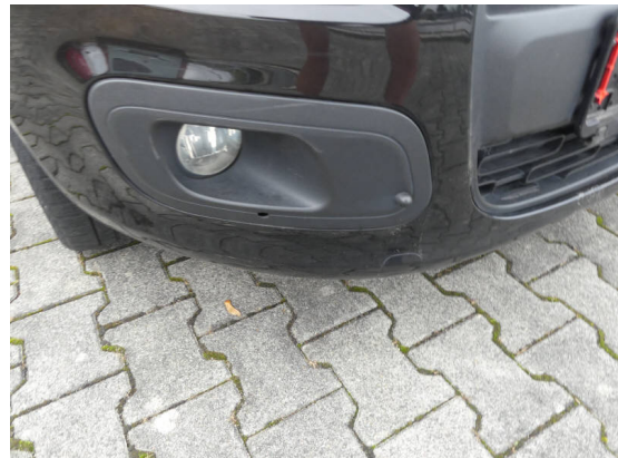
Bild 4: Karosserie / Blende im Stoßfänger vorne rechts Kratzer
