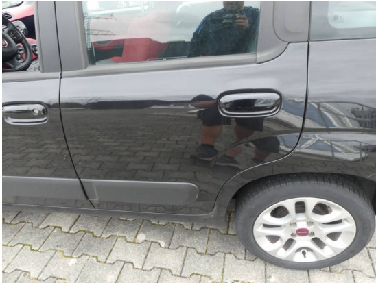
Bild 7: Karosserie / Tür hinten links zerkratzt
