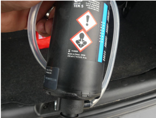
Bild 13: Reifen - Felge / Reifendichtmittel abgelaufen
