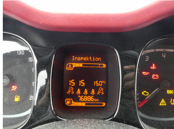
Bild 2: Wartung-Pflege / Wartung fällig
