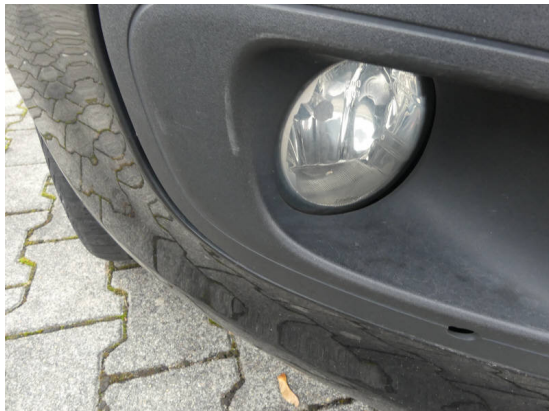
Bild 3: Karosserie / Blende im Stoßfänger vorne rechts Kratzer
