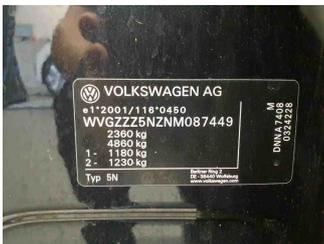
Fahrzeug - Typenschild/Fahrgestellnummer
