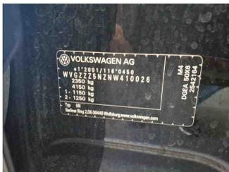
Fahrzeug - Typenschild/Fahrgestellnummer
