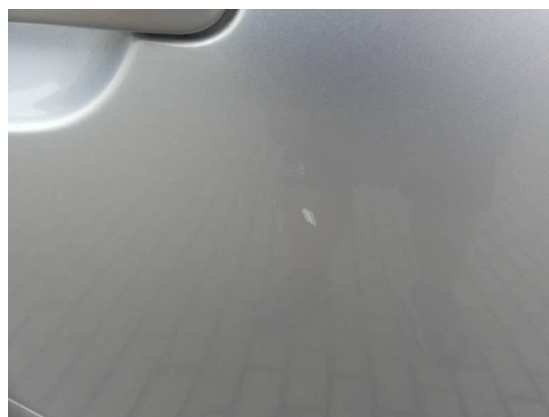
Bild 10: Karosserie / Tür hinten rechts Delle mit Kratzer und zerkratzt
