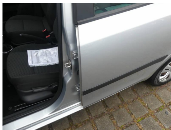
Bild 24: Karosserie / B-Säule links Dellen und zerkratzt
