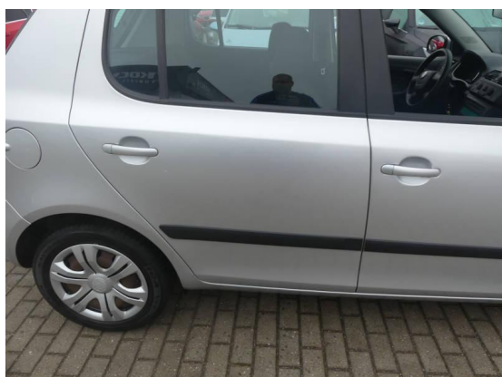
Bild 11: Karosserie / Tür hinten rechts Delle mit Kratzer und zerkratzt
