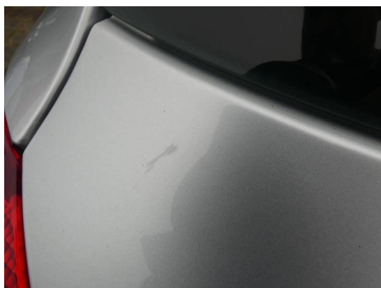
Bild 4: Karosserie / Heckklappe zerkratzt
