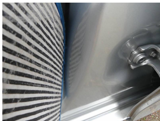
Bild 22: Karosserie / B-Säule links Dellen und zerkratzt
