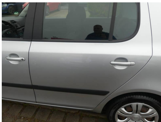
Bild 32: Karosserie / Tür hinten links Kratzer
