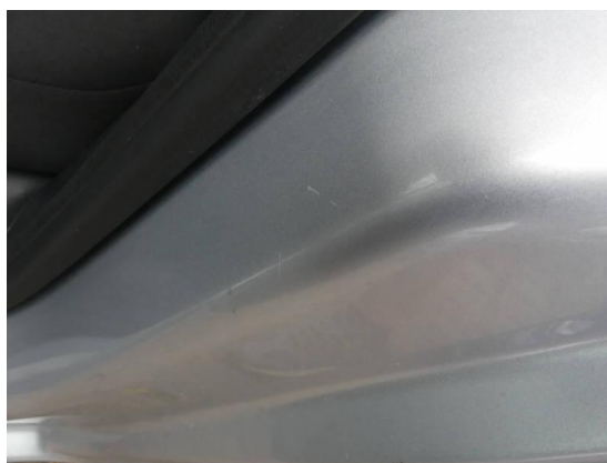
Bild 28: Karosserie / Einstieg hinten links zerkratzt
