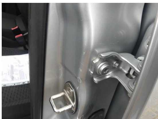
Bild 23: Karosserie / B-Säule links Dellen und zerkratzt
