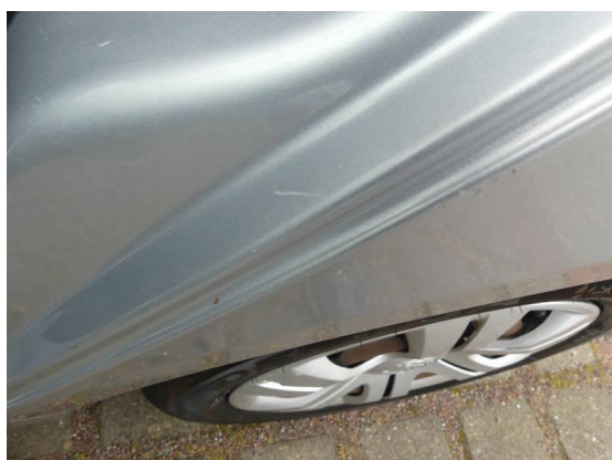
Bild 29: Karosserie / Einstieg hinten links zerkratzt
