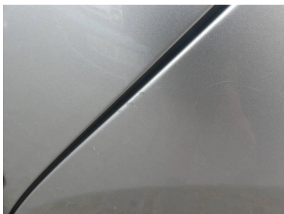
Bild 33: Karosserie / Seitenteil links Lackabplatzer
