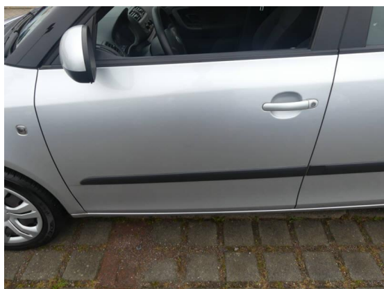
Bild 27: Karosserie / Tür vorne links Delle und zerkratzt
