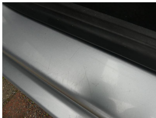
Bild 20: Karosserie / Einstieg vorne links zerkratzt
