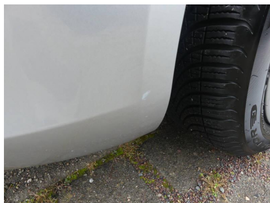
Bild 16: Karosserie / Stoßfänger vorn zerkratzt
