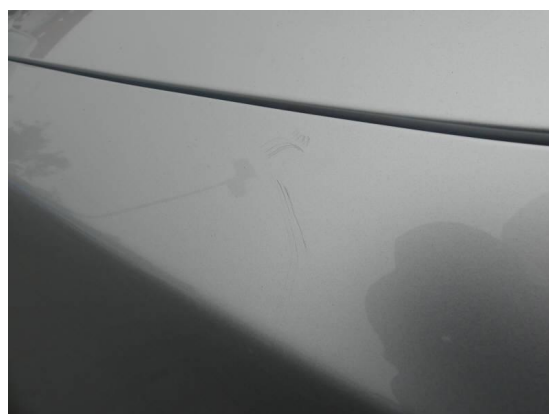
Bild 18: Karosserie / Kotflügel links zerkratzt
