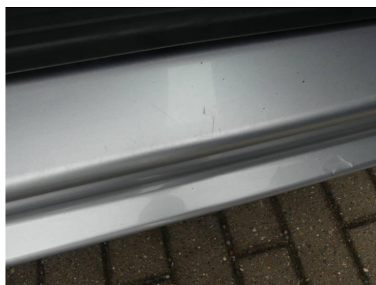
Bild 12: Karosserie / Einstieg vorne rechts zerkratzt
