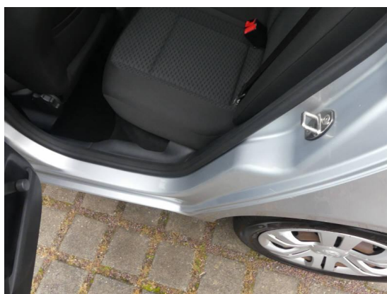
Bild 30: Karosserie / Einstieg hinten links zerkratzt
