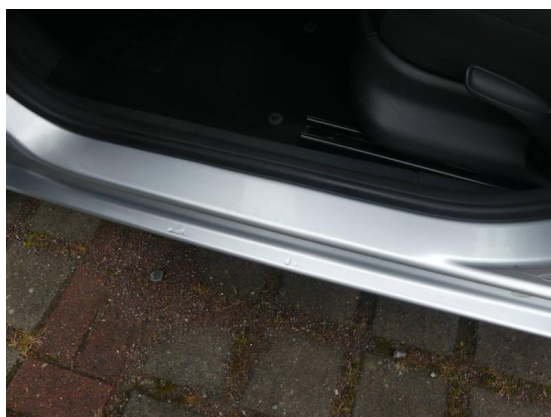
Bild 21: Karosserie / Einstieg vorne links zerkratzt
