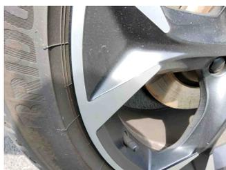
2 - Alufelge glanzgedreht vorne links - Abweichend vom Auslieferungszustand/-umfang - Ersetzen
