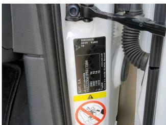
Fahrzeug - Typenschild/Fahrgestellnummer
