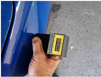
Lackstärke Kotflügel vorne links
