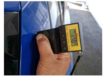
Lackstärke Seitenwand hinten rechts
