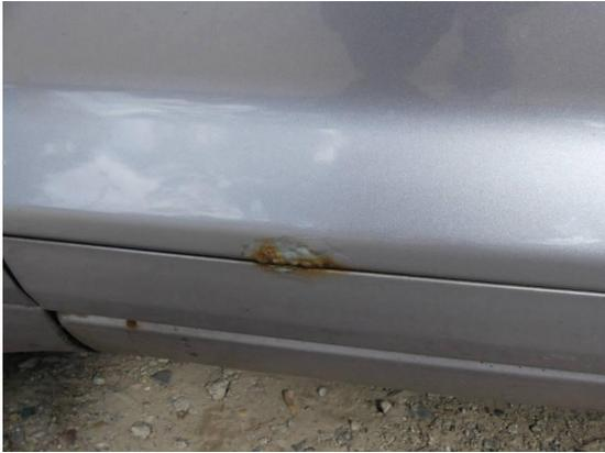
Bild 13: Karosserie / Tür links Korrosion
