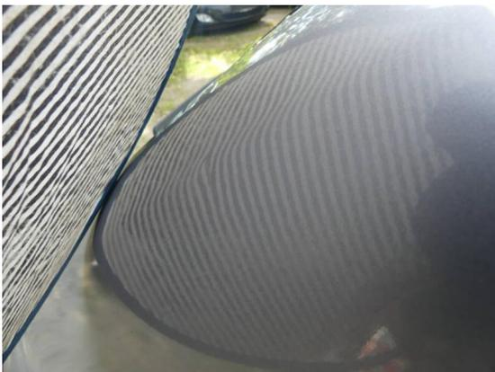
Bild 21: Karosserie / Seitenteil rechts leicht deformiert und zerkratzt
