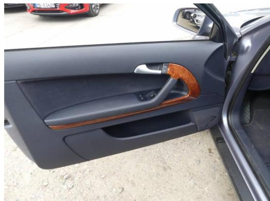
Bild 12: Innenraum / Lautsprecherabdeckung Tür links gebrochen
