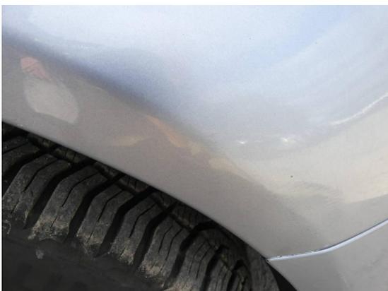
Bild 5: Karosserie / Kotflügel rechts zerkratzt
