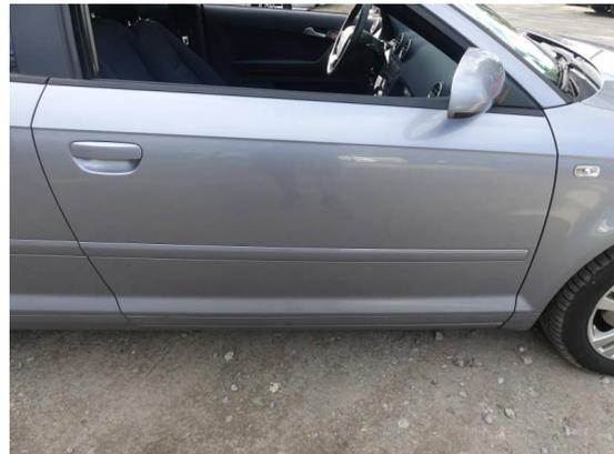
Bild 4: Karosserie / Tür rechts Delle mit Lackschaden und Korrosion
