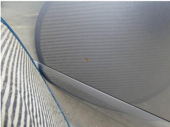
Bild 3: Karosserie / Tür rechts Delle mit Lackschaden und Korrosion
