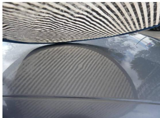
Bild 18: Karosserie / Dach Dellen
