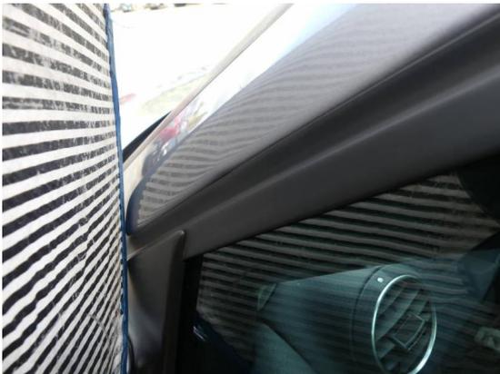
Bild 9: Karosserie / A-Säule links leicht deformiert
