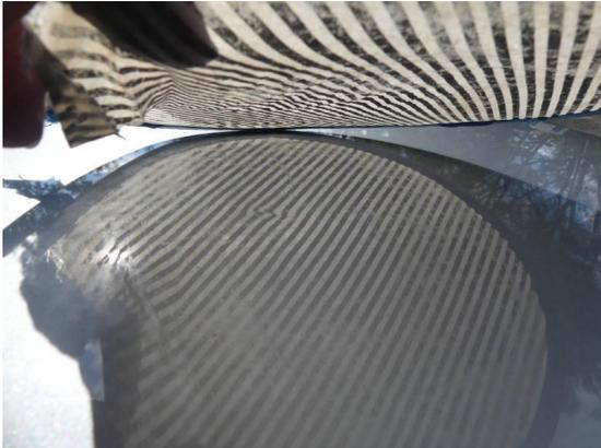
Bild 19: Karosserie / Dach Dellen
