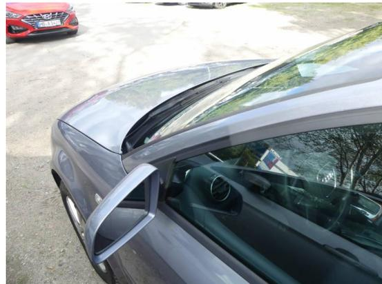
Bild 10: Karosserie / A-Säule links leicht deformiert
