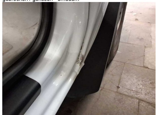
Beschädigung #12: Kotflügel rechts: Kotflügel rechts - Kratzer - Smart Repair
