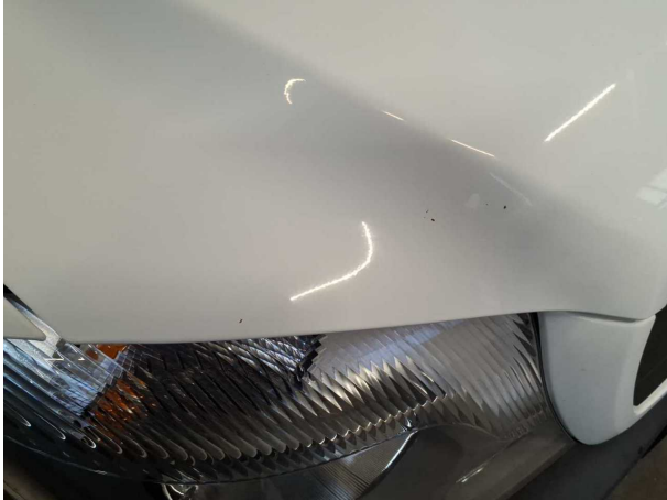
Beschädigung #8: Motorhaube: Motorhaube - Steinschlag
