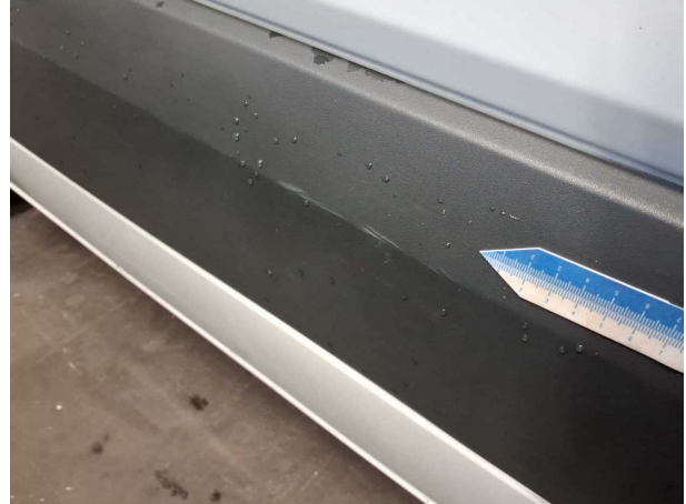
Beschädigung #14: Schiebetür rechts: Schutzleiste - verkratzt / verschürft - erneuern
