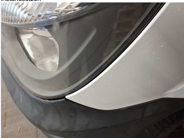
Beschädigung #9: Kotflügel links: Kotflügel links - lose - instandsetzen
