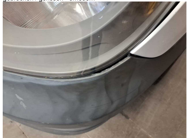
Beschädigung #11: Stossfänger vorn: Stossfänger vorn - gebrochen / gerissen - erneuern
