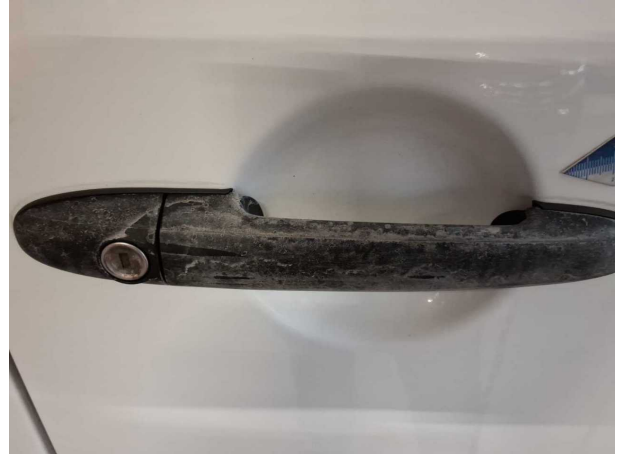
Beschädigung #15: Heckklappe/-tür: Griff außen - Lackman... - instandsetzen
