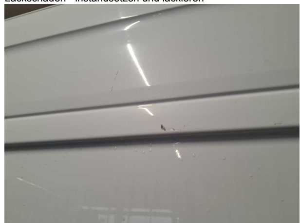
Beschädigung #13: Schiebetür rechts: Schiebetür - Delle / Lackschaden - instandsetzen und lackieren
