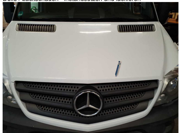
Beschädigung #8: Motorhaube: Motorhaube - Steinschlag
