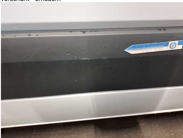
Beschädigung #14: Schiebetür rechts: Schutzleiste - verkratzt / verschürft - erneuern
