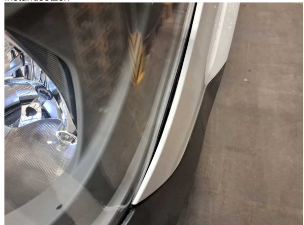
Beschädigung #9: Kotflügel links: Kotflügel links - lose - instandsetzen
