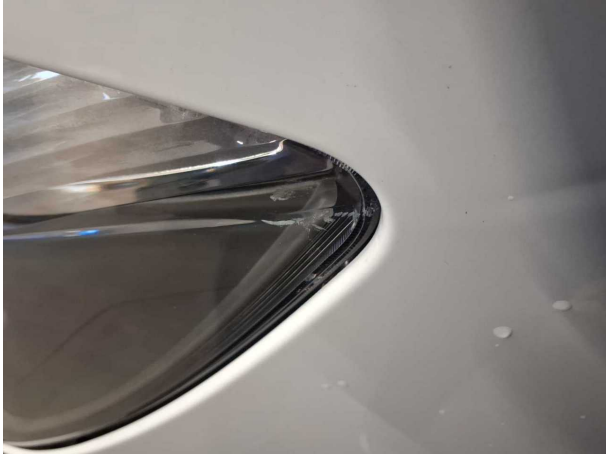
Beschädigung #10: Scheinwerfer: Scheinwerfer links - gebroche... gerissen - erneuern
