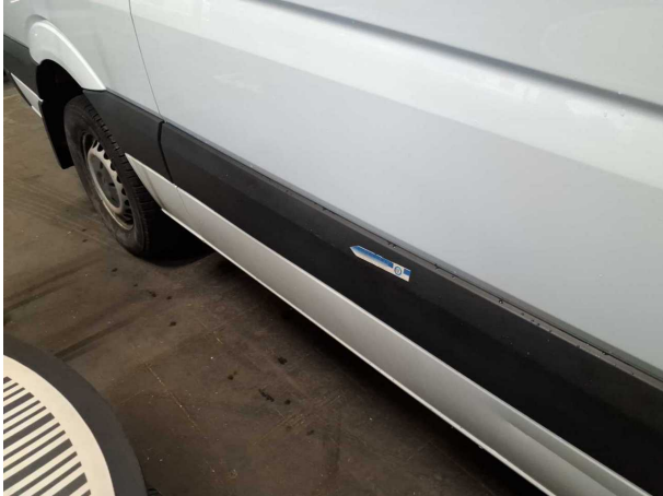
Beschädigung #14: Schiebetür rechts: Schutzleiste - verkratzt / verschürft - erneuern
