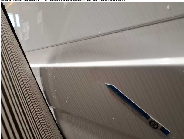
Beschädigung #17: Seitenwand links: Seitenwand - Delle / Lackschaden - instandsetzen und lackieren
