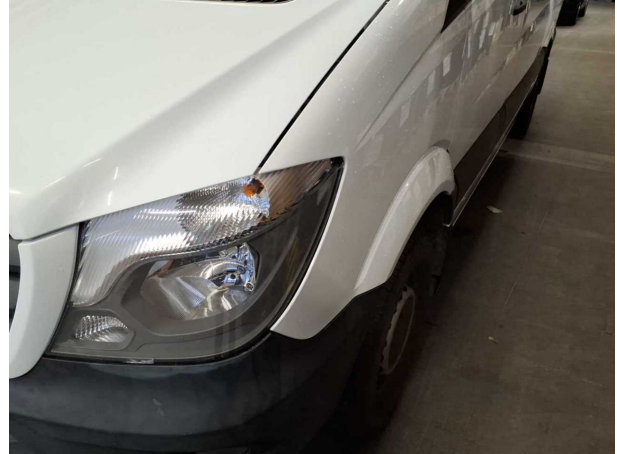
Beschädigung #9: Kotflügel links: Kotflügel links - lose - instandsetzen
