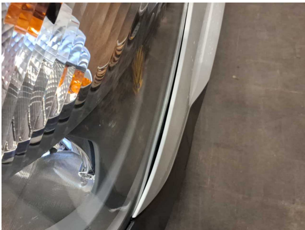
Beschädigung #9: Kotflügel links: Kotflügel links - lose - instandsetzen
