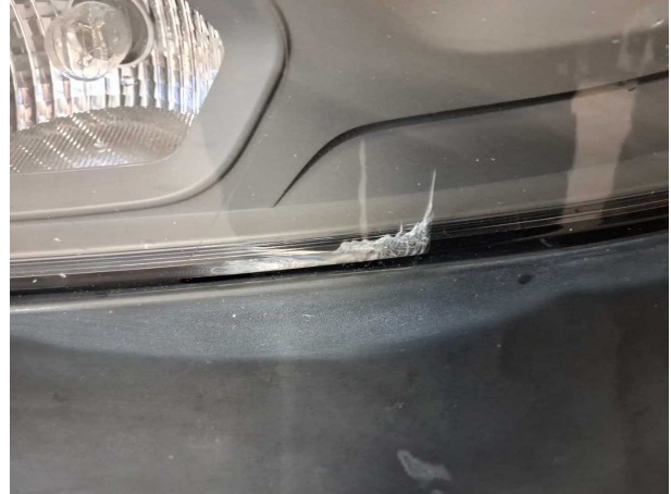
Beschädigung #10: Scheinwerfer: Scheinwerfer links - gebrochen / gerissen - erneuern
