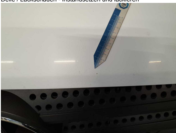
Beschädigung #8: Motorhaube: Motorhaube - Steinschlag
