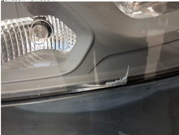
Beschädigung #10: Scheinwerfer: Scheinwerfer links - gebroche... gerissen - erneuern
