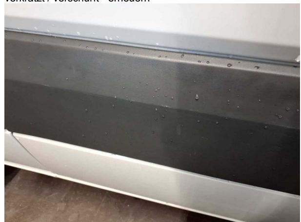
Beschädigung #14: Schiebetür rechts: Schutzleiste - verkratzt / verschürft - erneuern
