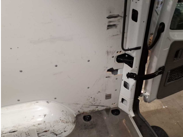
Beschädigung #1: Seitenwand rechts: Innenverkleidung - gebrochen / gerissen - erneuern
