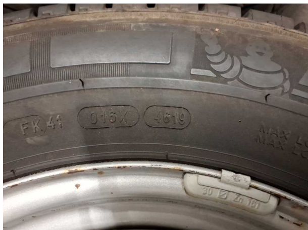
Beschädigung #19: 2.Radsatz: Reifensatz komplett (Reifenalter)
