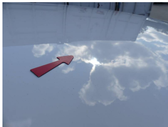
Bild 6: Karosserie / Dach Dellen
