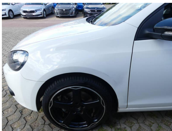
Bild 28: Karosserie / Kotflügel vorne links deformiert
