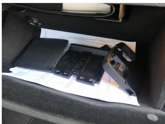
Bild 17: Innenraum / Abdeckung Mittelkonsole hinten gebrochen
