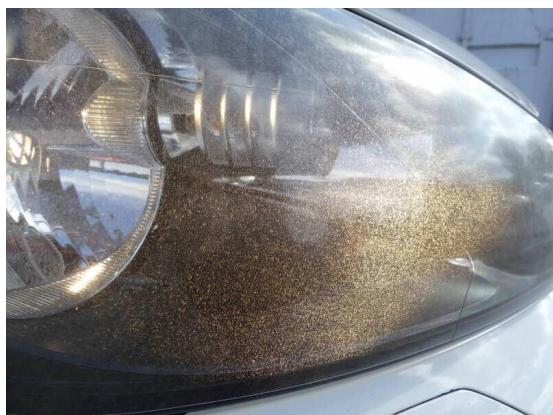
Bild 37: Technik / Scheinwerfer rechts verkratzt
