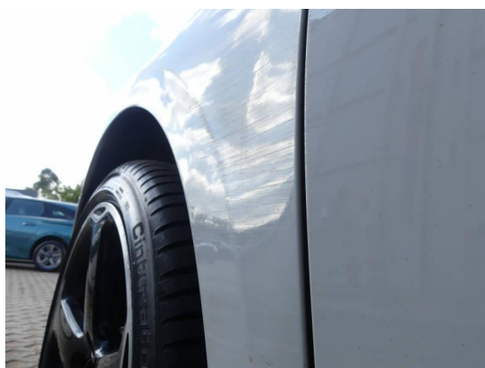
Bild 30: Karosserie / Kotflügel vorne links deformiert
