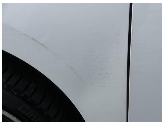
Bild 29: Karosserie / Kotflügel vorne links deformiert
