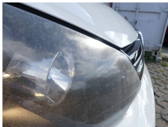
Bild 38: Technik / Scheinwerfer rechts verkratzt
