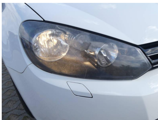
Bild 36: Technik / Scheinwerfer rechts verkratzt
