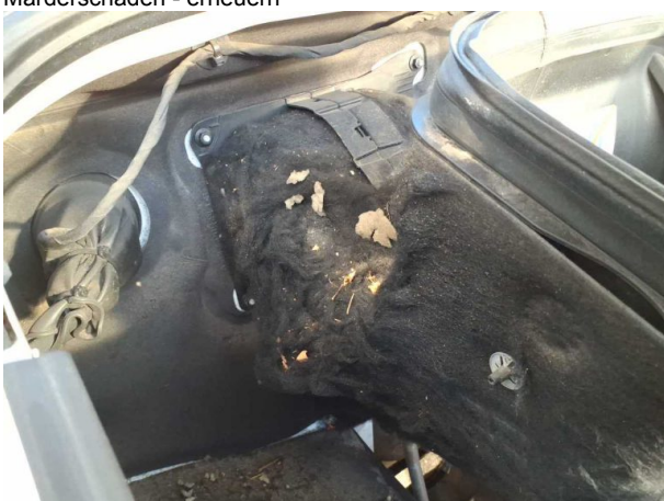
Beschädigung #4: Motor: Motorabdeckung (Dämmmatte) - Marderschaden - erneuern
