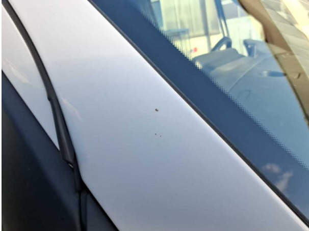
Beschädigung #16: Karosserie: A-Säule rechts - Steinschlag
