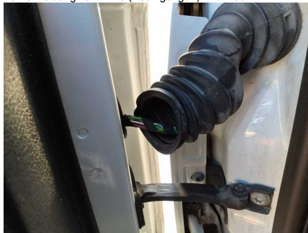
Beschädigung #2: Tür vorn links: Tür (Abdeckung Kabelstrang) - gebrochen / gerissen - erneuern
