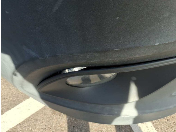
Beschädigung #10: Stossfänger vorn: Blende Stossfänger vorn - lose - instandsetzen
