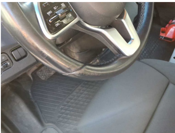
Beschädigung #19: Lenkanlage: Lenkrad - Abrieb - Smart Repair
