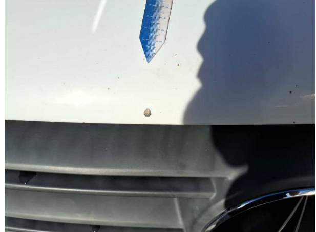
Beschädigung #9: Motorhaube: Motorhaube - Steinschlag - instandsetzen und lackieren
