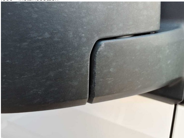
Beschädigung #11: Außenspiegel rechts: Spiegelgehäuse - verkratzt / verschürft - erneuern
