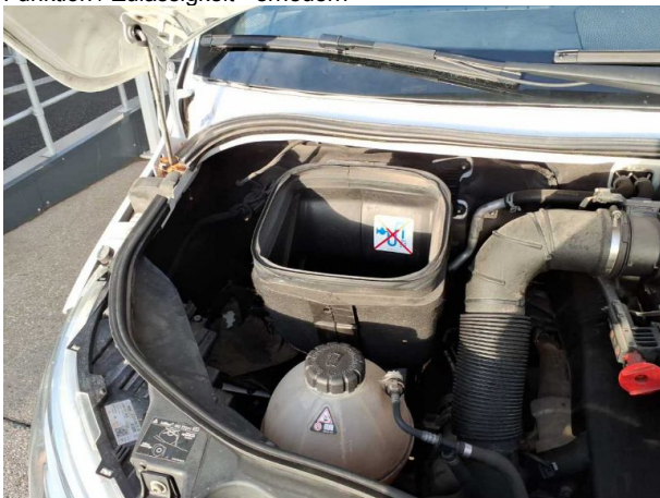
Beschädigung #4: Motor: Motorabdeckung (Dämmmatte) - Marderschaden - erneuern
