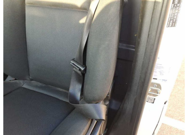
Beschädigung #3: Gurtsystem vorn: Sicherheitsgurt vorn links - Funktion / Zulässigkeit - erneuern
