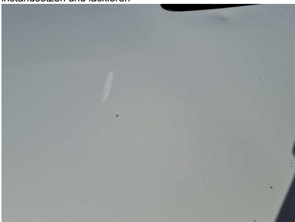
Beschädigung #9: Motorhaube: Motorhaube - Steinschlag - instandsetzen und lackieren
