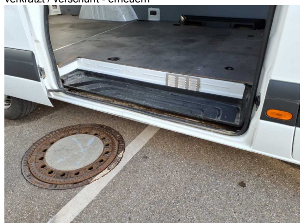
Beschädigung #12: Schweller rechts: Schweller - verkratzt / verschürft - instandsetzen und lackieren
