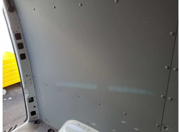
Beschädigung #5: Interieur: Laderaumboden (und Verkleidungen) - verkratzt / verschürft
