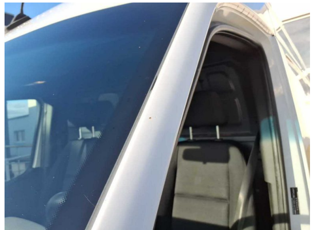
Beschädigung #17: Karosserie: A-Säule links - Steinschlag
