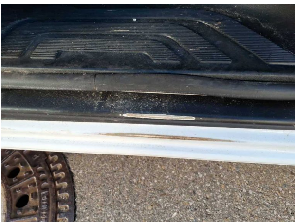
Beschädigung #21: Schweller links: Einstieg - verkratzt / versch... - Smart Repair
