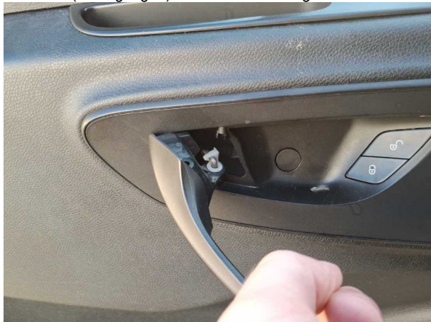
Beschädigung #1: Verkleidungen/Abdeckungen: Türverkleidung vorn links (Bedingungen) - Funktion / Zulässigkeit - erneuern
