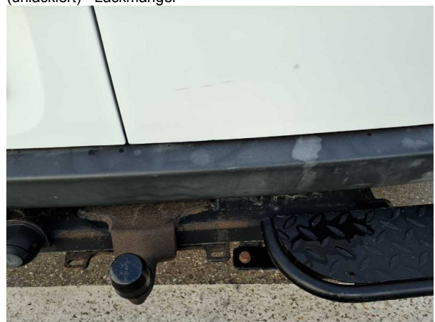
Beschädigung #14: Stossfänger hinten: Stossfänger hinten (unlackiert) - Lackmangel
