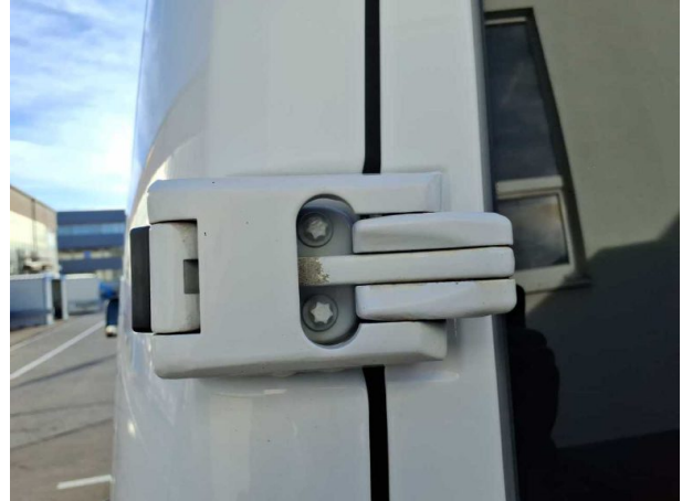
Beschädigung #13: Heckklappe/-tür: Scharnier unten (270 Grad) - verkratzt / verschürft - instandsetzen
