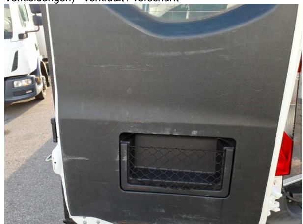
Beschädigung #5: Interieur: Laderaumboden (und Verkleidungen) - verkratzt / verschürft
