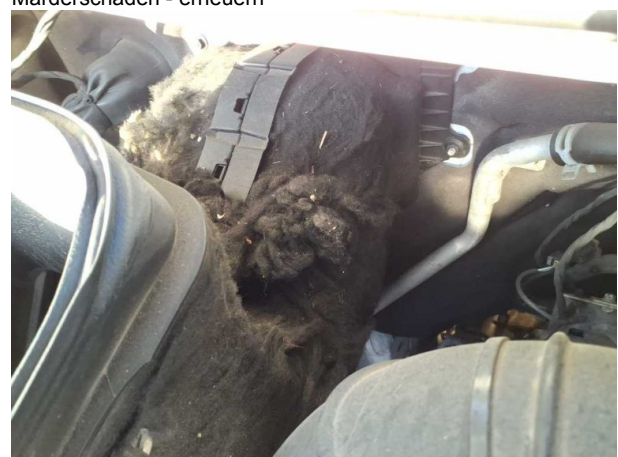
Beschädigung #4: Motor: Motorabdeckung (Dämmmatte) - Marderschaden - erneuern
