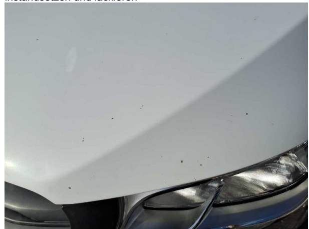
Beschädigung #9: Motorhaube: Motorhaube - Steinschlag - instandsetzen und lackieren
