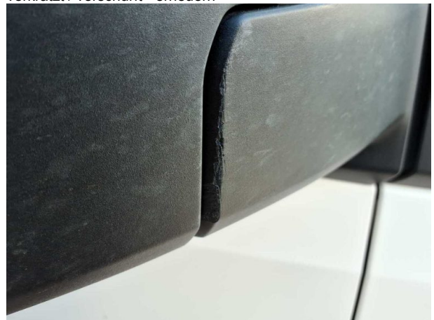
Beschädigung #11: Außenspiegel rechts: Spiegelgehäuse - verkratzt / verschürft - erneuern
