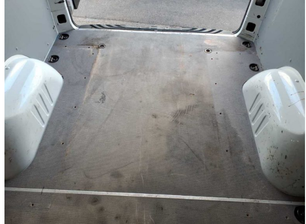
Beschädigung #5: Interieur: Laderaumboden (und Verkleidungen) - verkratzt / verschürft
