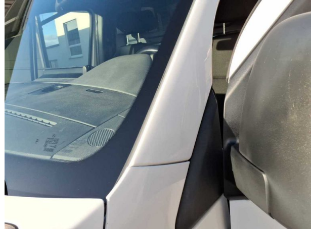
Beschädigung #17: Karosserie: A-Säule links - Steinschlag
