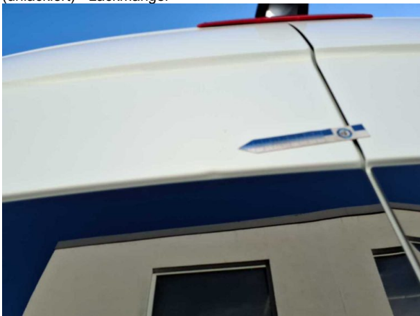
Beschädigung #15: Heckklappe/-tür: Hecktür links - Delle / Lackschaden - instandsetzen und lackieren
