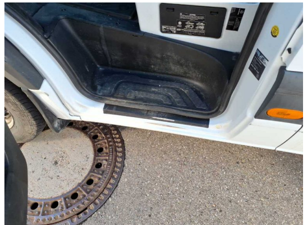
Beschädigung #21: Schweller links: Einstieg - verkratzt / verschürft - Smart Repair
