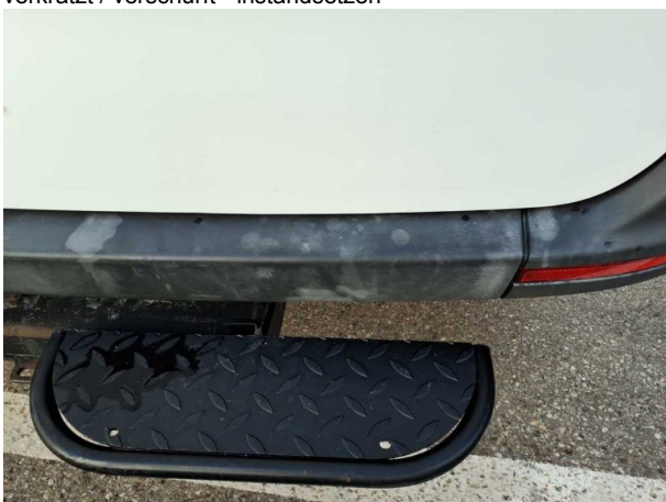
Beschädigung #14: Stossfänger hinten: Stossfänger hinten (unlackiert) - Lackmangel
