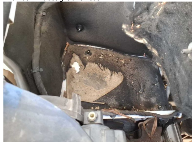
Beschädigung #4: Motor: Motorabdeckung (Dämmmatte) - Marderschaden - erneuern
