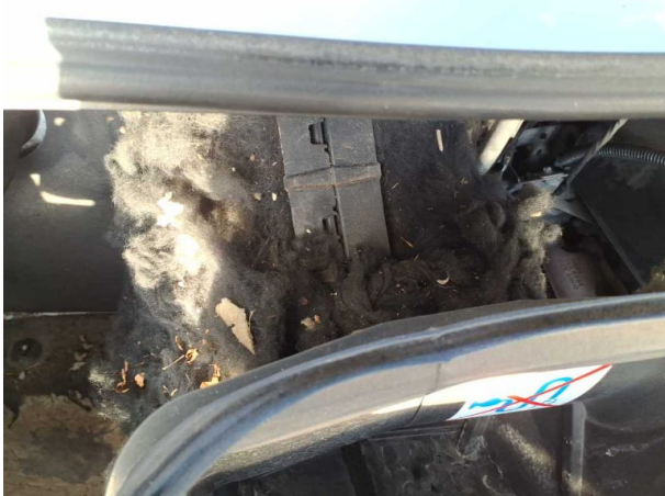
Beschädigung #4: Motor: Motorabdeckung (Dämmmatte) - Marderschaden - erneuern
