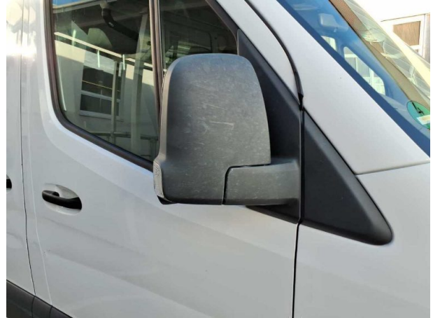
Beschädigung #11: Außenspiegel rechts: Spiegelgehäuse - verkratzt / verschürft - erneuern
