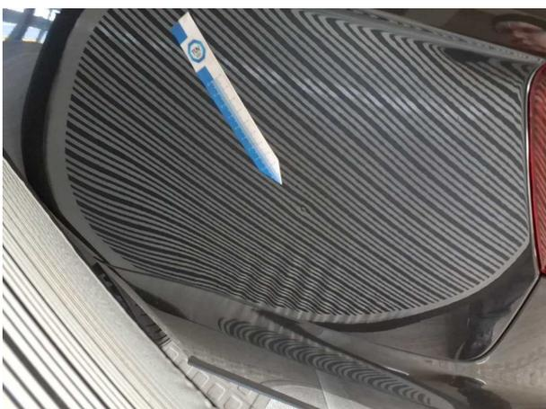
**Beschädigung #23:** Seitenwand links: Seitenwand - Delle(n)
