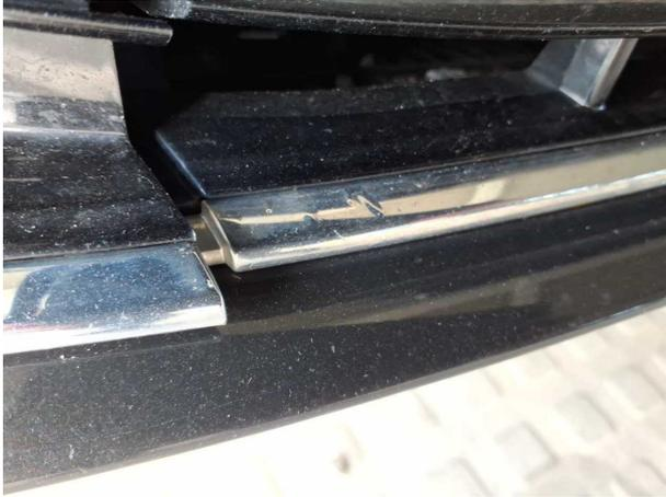
**Beschädigung #27:** Stossfänger vorn: Blende Stossfänger vorn (Mitte) - Lackmangel - instandsetzen
