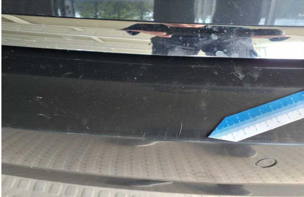
**Beschädigung #20:** Stossfänger hinten: Stossfänger hinten - Kratzer - Smart Repair
