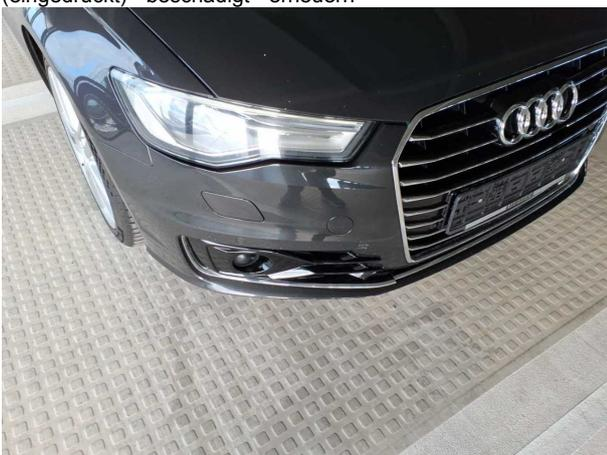
**Beschädigung #14:** Stossfänger vorn: Blende Stossfänger vorn - lose - instandsetzen
