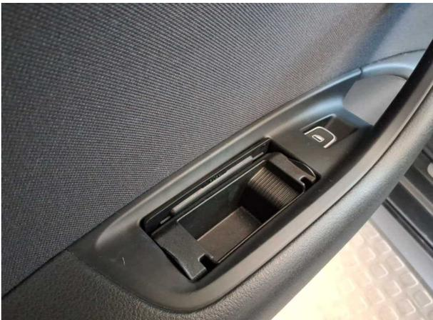
**Beschädigung #2:** Verkleidungen/Abdeckungen: Türverkleidung hinten links (Ablagefach) - gebrochen / gerissen - erneuern
