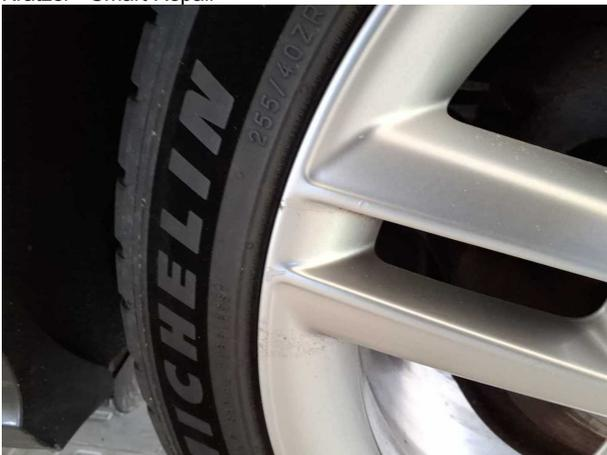
**Beschädigung #9:** Rad/Reifen: Leichtmetallfelge hinten links - Kratzer - Smart Repair
