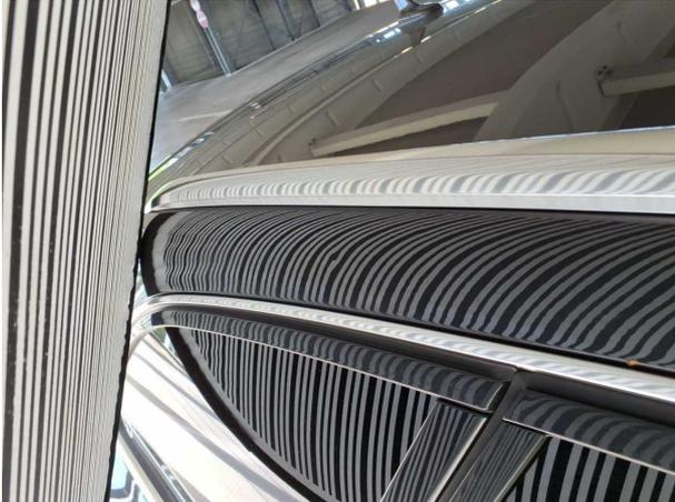
**Beschädigung #26:** Fahrzeugdach: Dachholm rechts (und Dellen, Matte Stellen) - Lackmangel - Smart Repair
