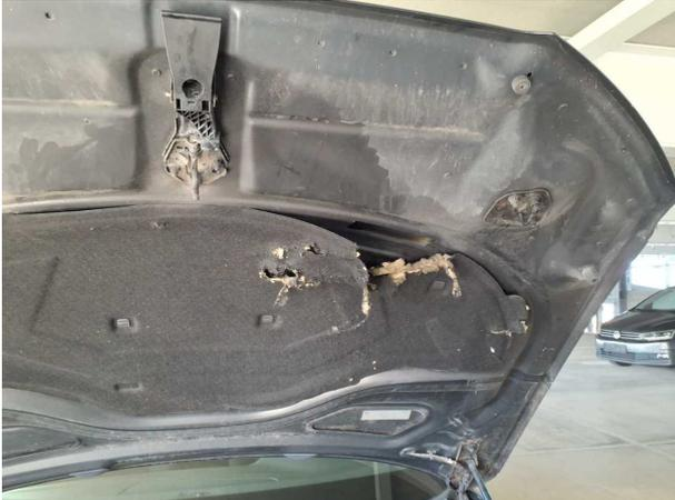
**Beschädigung #1:** Motorhaube: Dämmmatte - Marderschaden - erneuern
