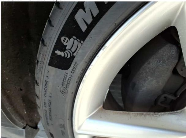
**Beschädigung #11:** Rad/Reifen: Leichtmetallfelge vorn rechts - Kratzer - Smart Repair
