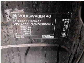
Fahrzeug - Typenschild/Fahrgestellnummer
