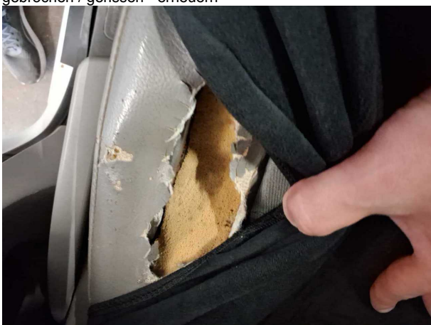
Beschädigung #17: Sitz vorn: Sitzbezug links (und Polster) - gebrochen / gerissen - erneuern
