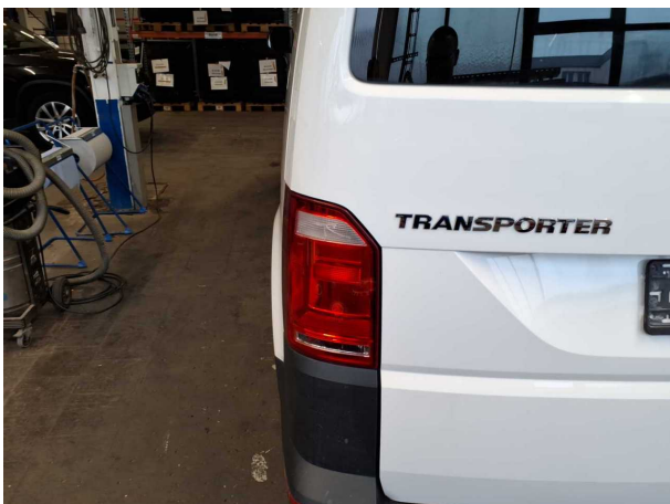
Beschädigung #24: Heckleuchte: Heckleuchte links - gebrochen / gerissen - erneuern
