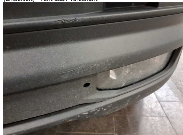
Beschädigung #12: Stossfänger vorn: Stossfänger vorn (unlackiert) - verkratzt / verschürft
