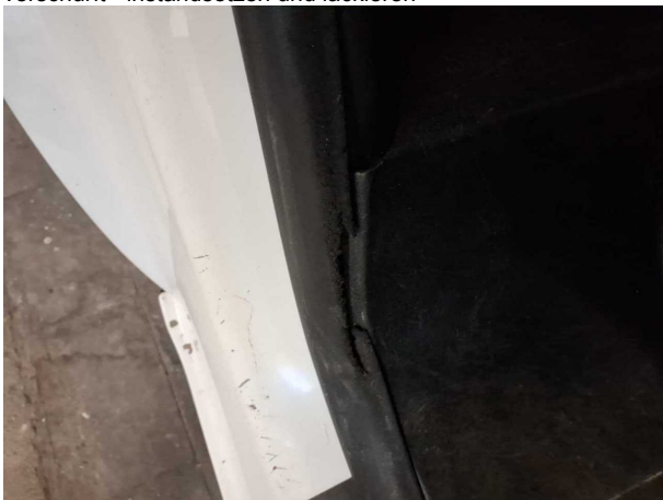
Beschädigung #15: Tür vorn links: Türdichtung - gebrochen / gerissen - erneuern
