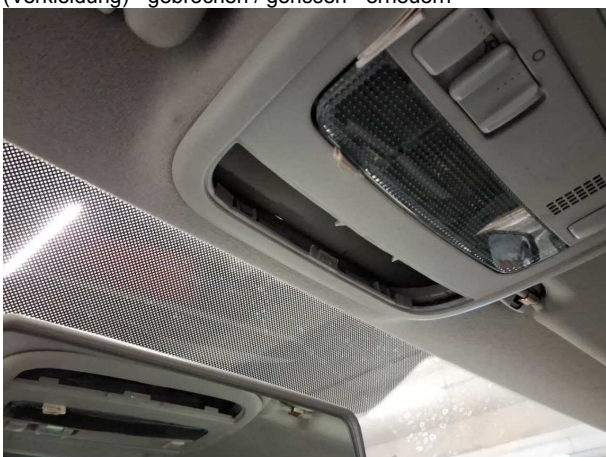
Beschädigung #8: Verkleidungen/Abdeckungen: Dachhimmel (Verkleidung) - gebrochen / gerissen - erneuern
