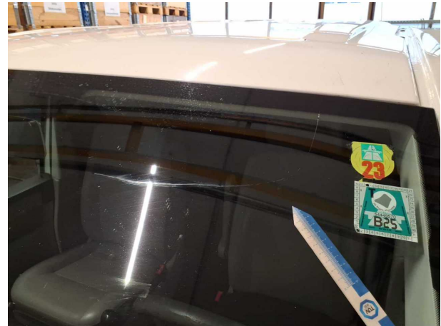
Beschädigung #11: Verglasung: Frontscheibe - gebrochen / gerissen - erneuern
