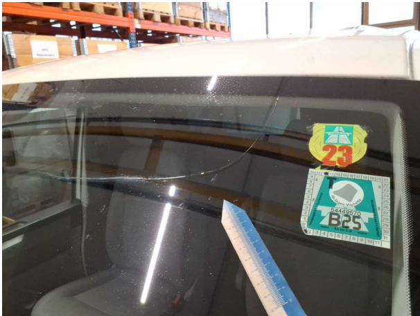
Beschädigung #11: Verglasung: Frontscheibe - gebrochen / gerissen - erneuern
