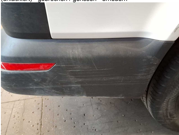
Beschädigung #25: Stossfänger hinten: Stossfänger hinten (unlackiert) - gebrochen / gerissen - erneuern
