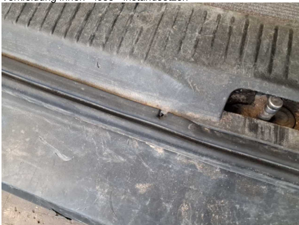
Beschädigung #33: Heckklappe/-tür: Dichtung - gebrochen / gerissen - erneuern
