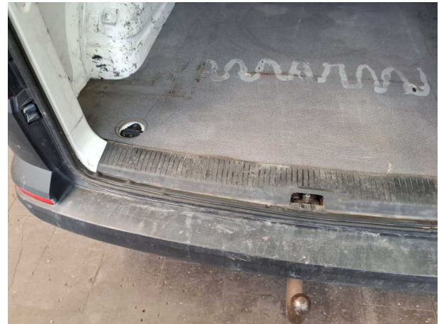
Beschädigung #5: Verkleidungen/Abdeckungen: Verkleidung Ladekante - gebrochen / gerissen - erneuern
