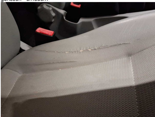
Beschädigung #31: Sitz vorn: Sitzbezug rechts - gebrochen / gerissen - erneuern
