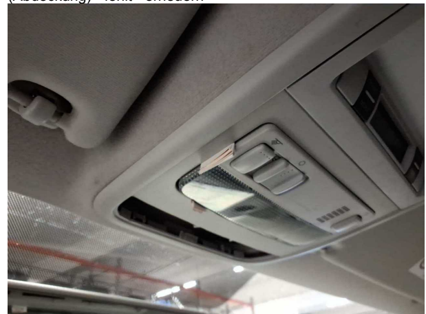
Beschädigung #8: Verkleidungen/Abdeckungen: Dachhimmel (Verkleidung) - gebrochen / gerissen - erneuern
