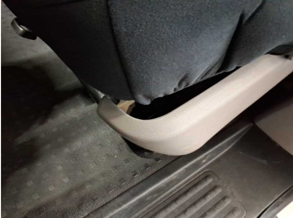
Beschädigung #18: Sitz vorn: Sitzkastenverkleidung links - lose - instandsetzen
