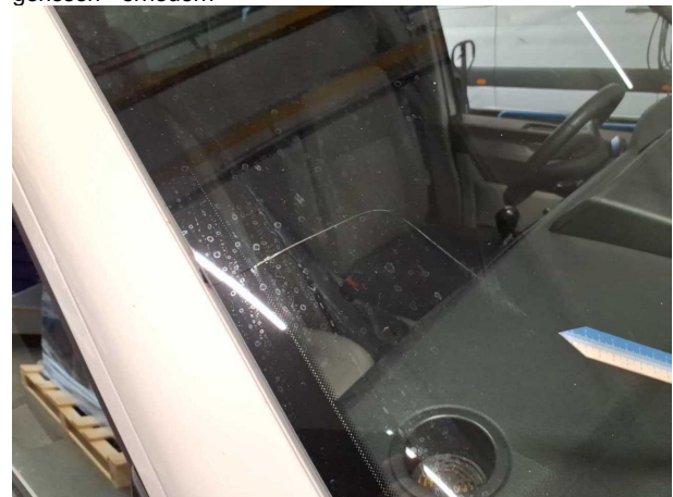
Beschädigung #11: Verglasung: Frontscheibe - gebrochen / gerissen - erneuern
