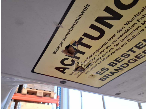
Beschädigung #6: Verkleidungen/Abdeckungen: Heckdeckel, Innenverkleidung - gebrochen / gerissen - erneuern
