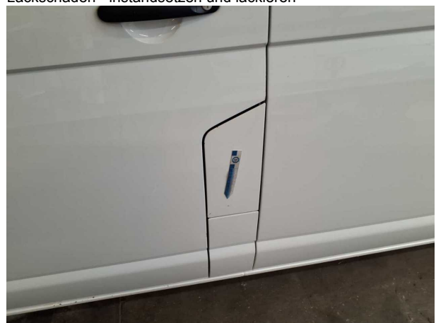
Beschädigung #22: Kraftstoffanlage: Tankdeckel - Kratzer - instandsetzen und lackieren
