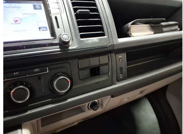
Beschädigung #7: Instrumententafel: Instrumententafel (Abdeckung) - fehlt - erneuern
