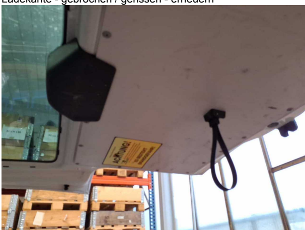
Beschädigung #6: Verkleidungen/Abdeckungen: Heckdeckel, Innenverkleidung - gebrochen / gerissen - erneuern
