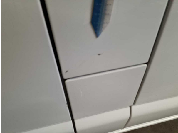
Beschädigung #22: Kraftstoffanlage: Tankdeckel - Kratzer - instandsetzen und lackieren
