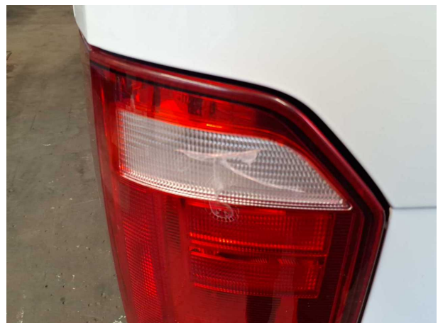
Beschädigung #24: Heckleuchte: Heckleuchte links - gebrochen / gerissen - erneuern
