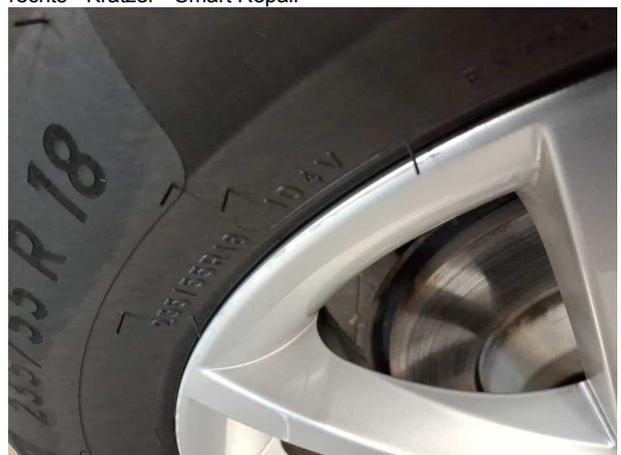
**Beschädigung #10:** Rad/Reifen: Leichtmetallfelge hinten rechts - Kratzer - Smart Repair
