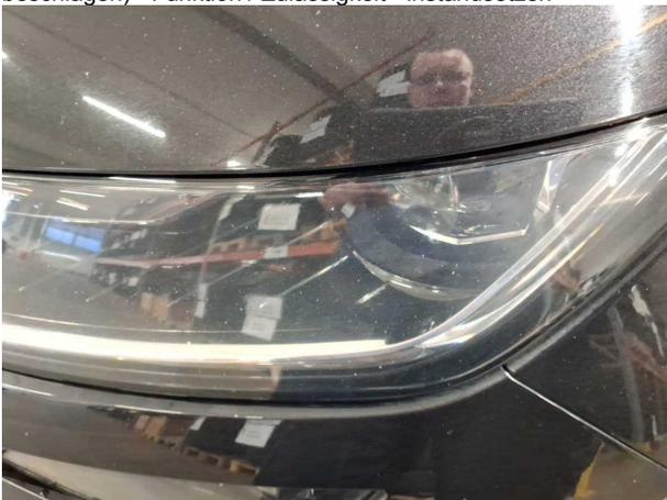
**Beschädigung #3:** Scheinwerfer: Scheinwerfer rechts (und links, beschlagen) - Funktion / Zulässigkeit - instandsetzen
