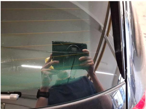
**Beschädigung #14:** Verglasung: Heckscheibe - Kratzer
