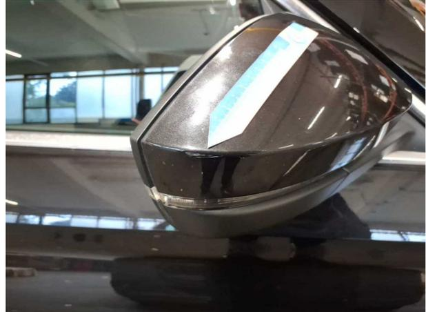
**Beschädigung #6:** Außenspiegel rechts: Abdeckkappe - Kratzer - instandsetzen und lackieren
