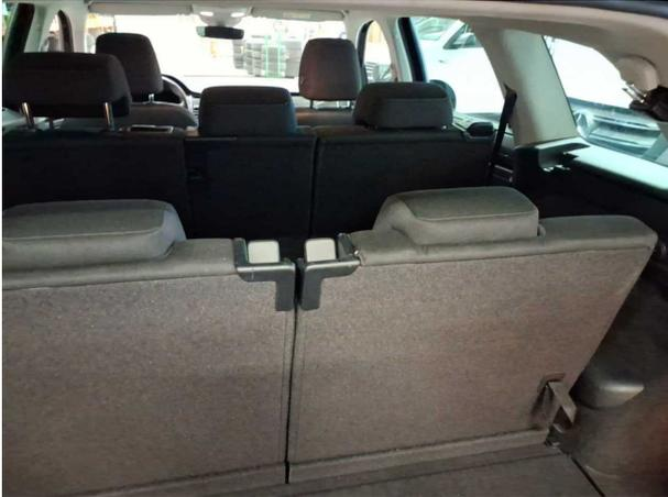
**Beschädigung #1:** Sitz hinten: Rücksitz - lose - instandsetzen
