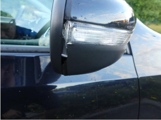
Bild 19: Karosserie / Spiegelgehäuse rechts gebrochen
