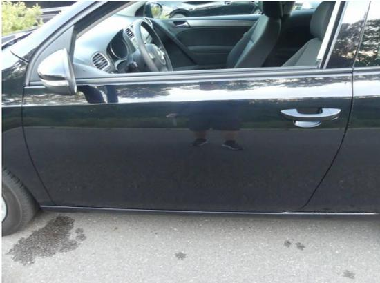
Bild 7: Karosserie / Tür links Delle
