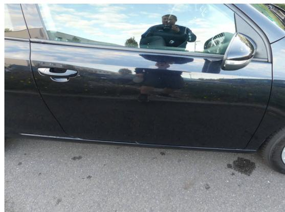
Bild 18: Karosserie / Tür rechts Delle und zerkratzt
