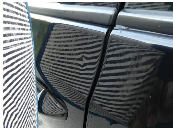
Bild 6: Karosserie / Tür links Delle
