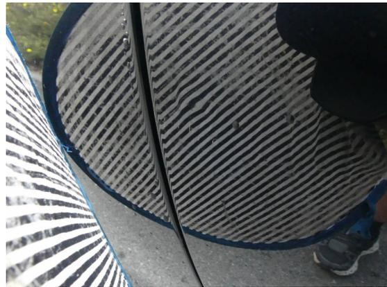
Bild 16: Karosserie / Tür rechts Delle und zerkratzt
