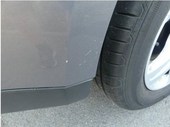
Bild 13: Karosserie / Stoßfänger hinten Kratzer
