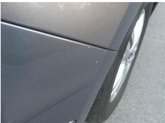
Bild 5: Karosserie / Stoßfänger vorn Steinschläge
