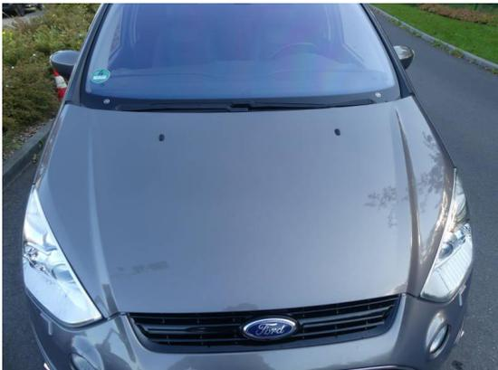
Bild 3: Karosserie / Motorhaube Steinschläge mit Korrosionsansatz
