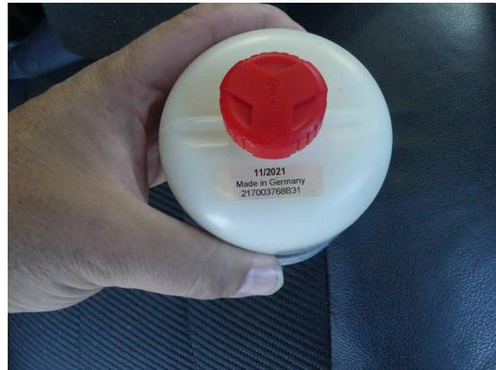
Bild 20: Reifen - Felge / Reifendichtmittel abgelaufen
