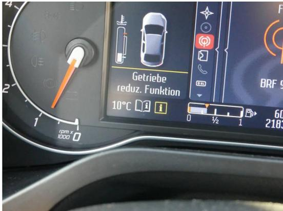
Bild 19: Technik / Getriebe wenn warm kein Vortrieb mehr
