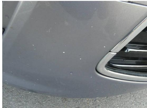
Bild 4: Karosserie / Stoßfänger vorn Steinschläge
