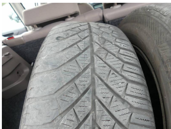
Bild 39: Reifen - Felge / Winterreifen vorne verschlissen
