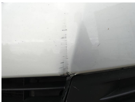
Bild 36: Karosserie / Stoßfänger vorne Kratzer+deformiert
