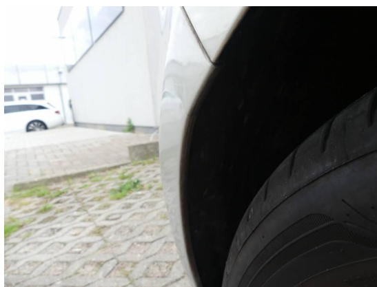
Bild 22: Karosserie / Stoßfänger hinten Kratzer+ leicht deformiert
