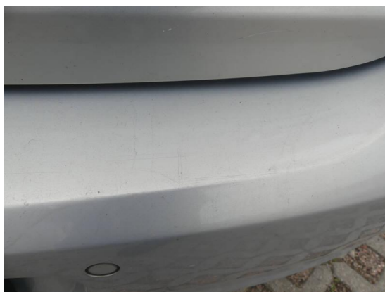
Bild 20: Karosserie / Stoßfänger hinten Kratzer+ leicht deformiert
