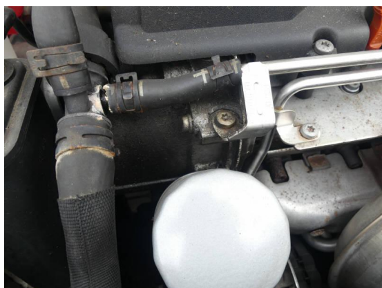
Bild 15: Technik / Motor Ölfeucht
