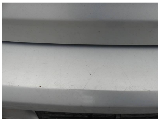
Bild 21: Karosserie / Stoßfänger hinten Kratzer+ leicht deformiert
