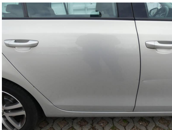
Bild 8: Karosserie / Tür hinten rechts deformiert
