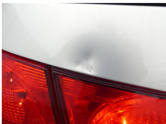
Bild 17: Karosserie / Heckklappe Delle+Kratzer
