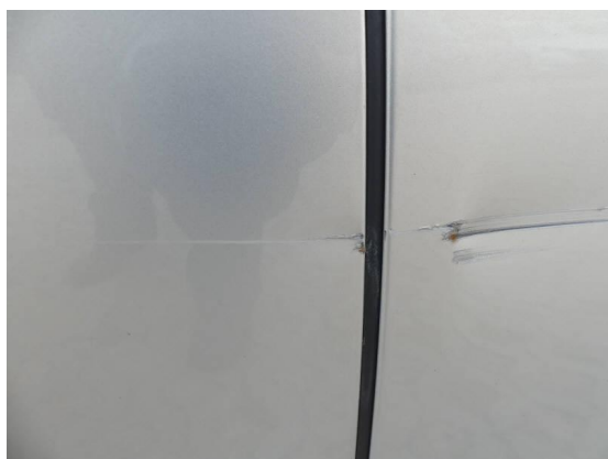
Bild 9: Karosserie / Tür hinten rechts deformiert
