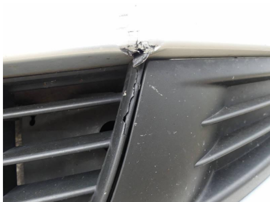
Bild 37: Karosserie / Stoßfänger vorne Kratzer+deformiert
