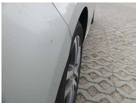
Bild 23: Karosserie / Stoßfänger hinten Kratzer+ leicht deformiert
