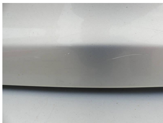
Bild 18: Karosserie / Heckklappe Delle+Kratzer
