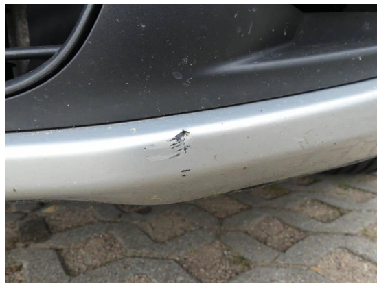
Bild 38: Karosserie / Stoßfänger vorne Kratzer+deformiert
