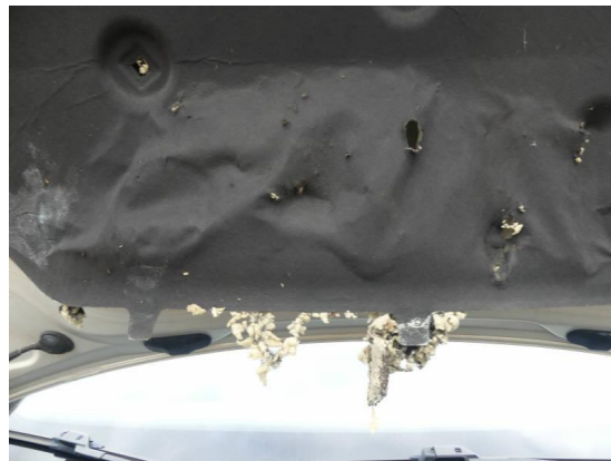
Bild 2: Karosserie / Motordämmmatte zerissen
