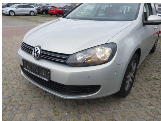
Bild 35: Karosserie / Stoßfänger vorne Kratzer+deformiert
