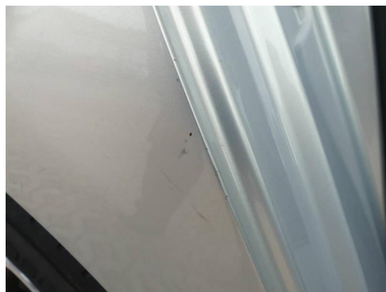
Bild 14: Karosserie / Fondseite rechts Korrosion+Kratzer
