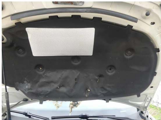
Bild 1: Karosserie / Motordämmmatte zerissen
