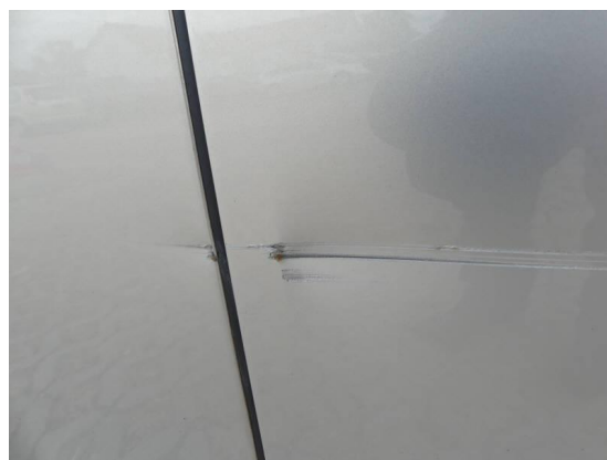
Bild 6: Karosserie / Tür vorne rechts deformiert
