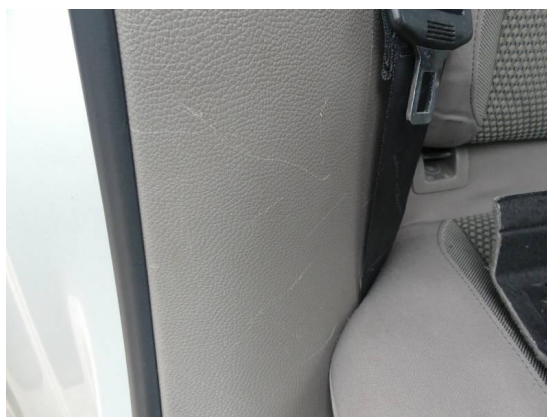
Bild 10: Innenraum / Seitenverkleidung Rücksitzbank Kratzer
