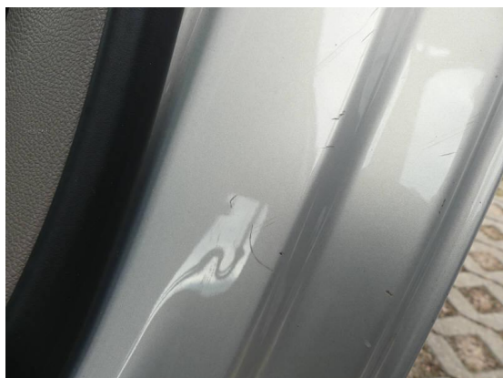
Bild 25: Karosserie / Einstieg hinten links Kratzer
