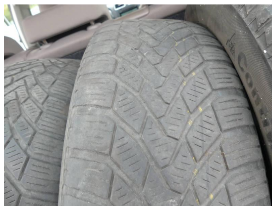
Bild 40: Reifen - Felge / Winterreifen vorne verschlissen
