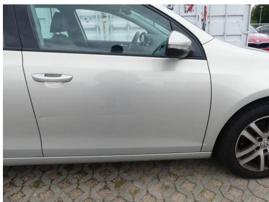
Bild 5: Karosserie / Tür vorne rechts deformiert
