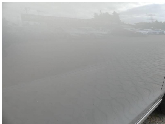
Bild 7: Karosserie / Tür vorne rechts deformiert
