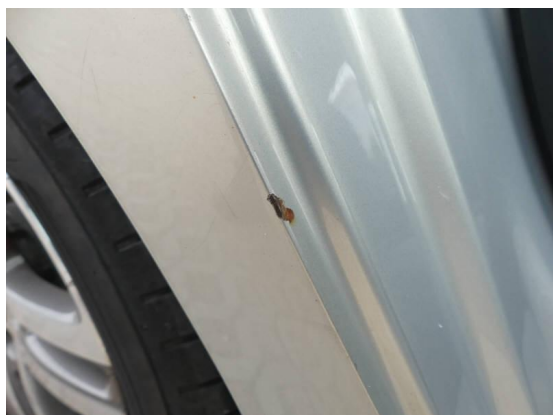
Bild 13: Karosserie / Fondseite rechts Korrosion+Kratzer
