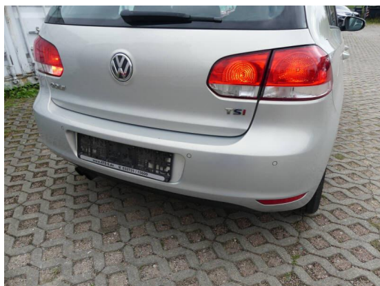
Bild 19: Karosserie / Stoßfänger hinten Kratzer+ leicht deformiert
