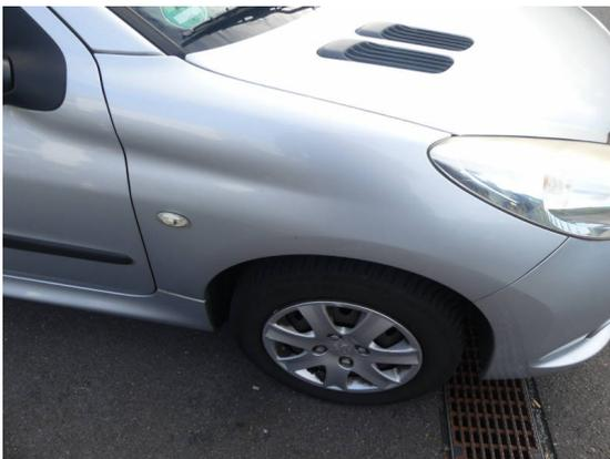
Bild 15: Karosserie / Kotflügel rechts Delle mit Kratzer
