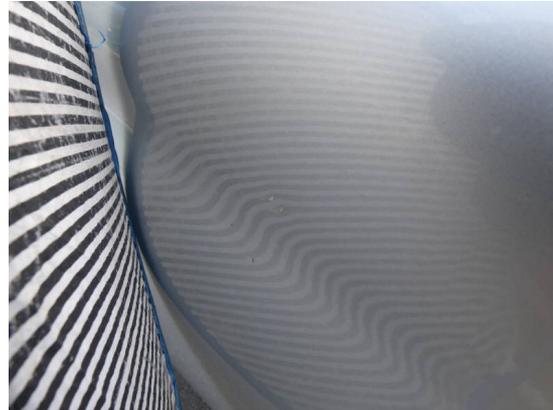
Bild 14: Karosserie / Kotflügel rechts Delle mit Kratzer
