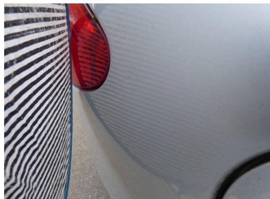
Bild 12: Karosserie / Seitenteil rechts Dellen mit Kratzer
