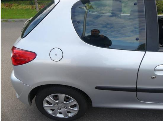
Bild 13: Karosserie / Seitenteil rechts Dellen mit Kratzer
