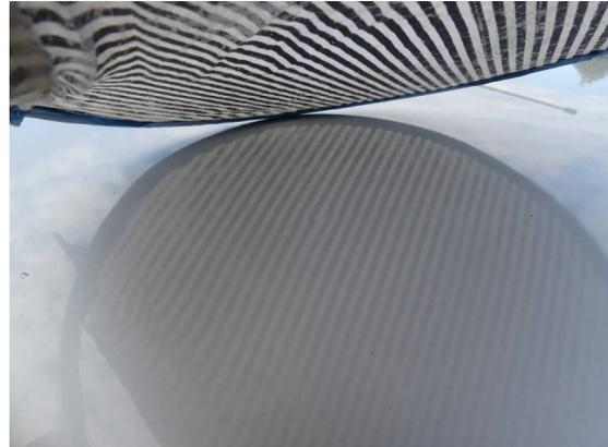
Bild 8: Karosserie / Dach Delle
