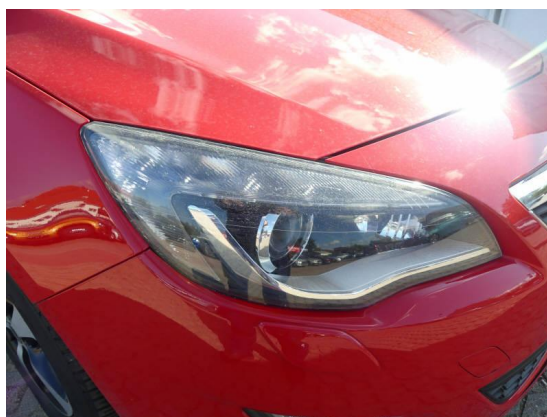
Bild 16: Technik / Scheinwerfer vorne rechts Zerkratzt
