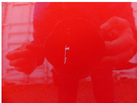
Bild 49: Karosserie / Tür hinten links Kratzer
