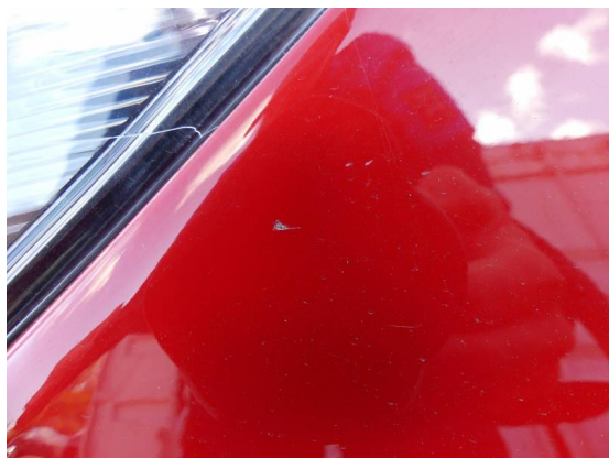
Bild 5: Karosserie / Kotflügel vorne links Kratzer
