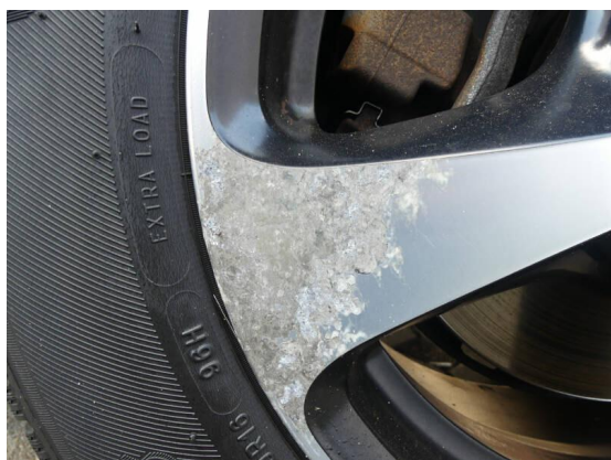
Bild 57: Reifen - Felge / Felge vorne links Lackschaden
