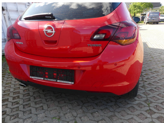
Bild 37: Karosserie / Stoßfänger hinten Kratzer+gebrochen
