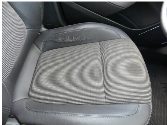
Bild 1: Innenraum / Sitzwange eingerissen
