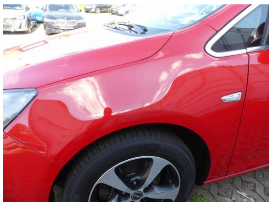
Bild 3: Karosserie / Kotflügel vorne links Kratzer
