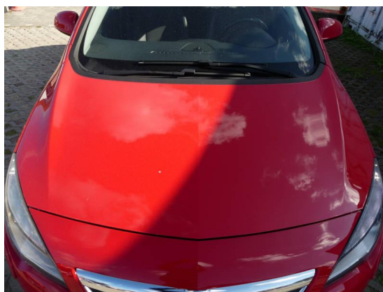
Bild 10: Karosserie / Motorhaube Steinschläge
