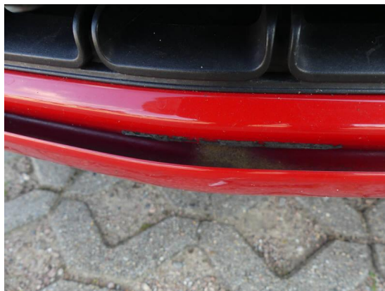
Bild 8: Karosserie / Stoßfänger vorne Krater/Steinschläge/gebrochen
