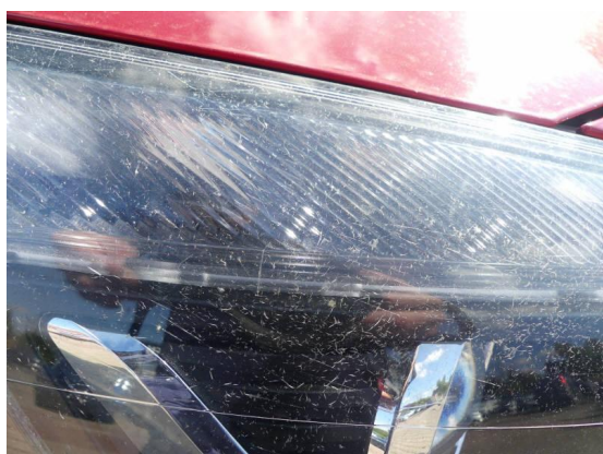
Bild 17: Technik / Scheinwerfer vorne rechts Zerkratzt
