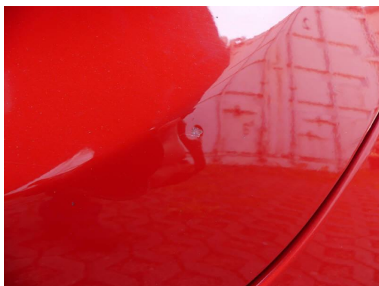
Bild 51: Karosserie / Tür hinten links Kratzer
