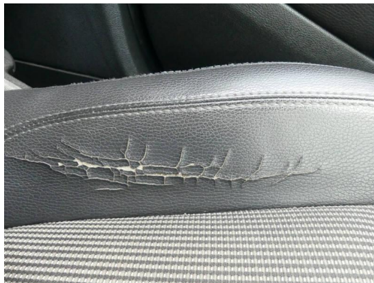
Bild 2: Innenraum / Sitzwange eingerissen
