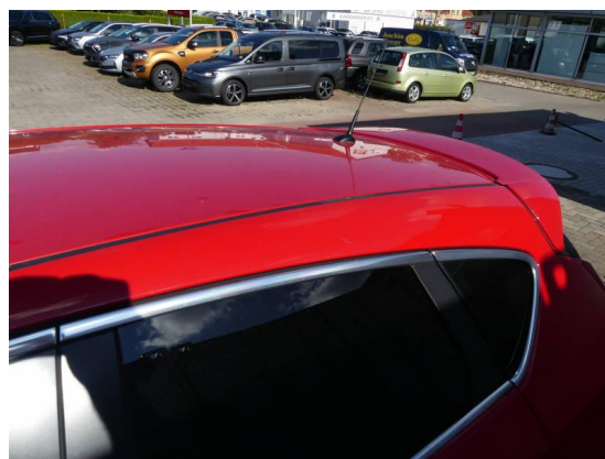
Bild 52: Karosserie / Dachholm links Dellen
