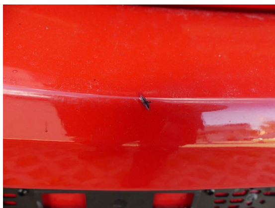
Bild 39: Karosserie / Stoßfänger hinten Kratzer+gebrochen
