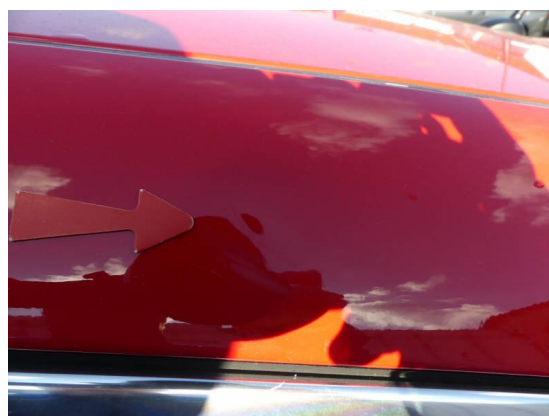
Bild 54: Karosserie / Dachholm links Dellen
