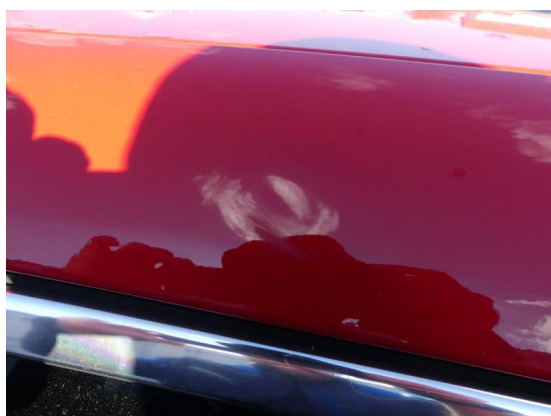
Bild 53: Karosserie / Dachholm links Dellen
