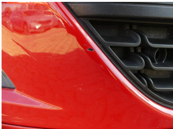
Bild 7: Karosserie / Stoßfänger vorne Krater/Steinschläge/gebrochen
