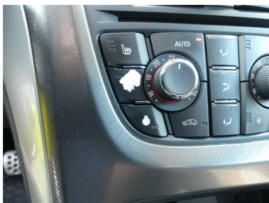
Bild 47: Innenraum / Bedientasten verschlissen
