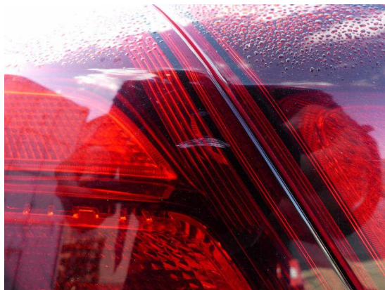
Bild 32: Karosserie / Rücklicht links Kratzer/Einriss
