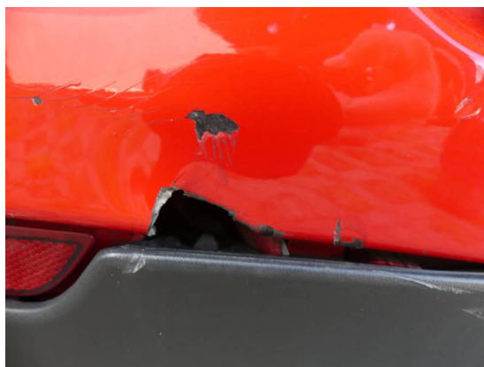
Bild 38: Karosserie / Stoßfänger hinten Kratzer+gebrochen
