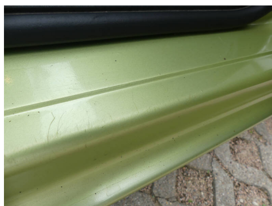
Bild 28: Karosserie / Einstieg vorne rechts Kratzer
