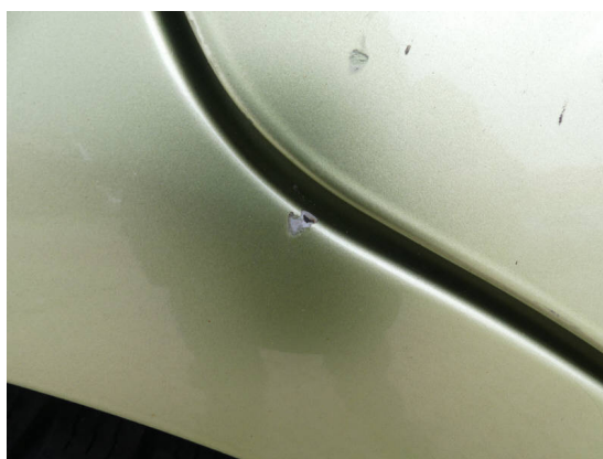
Bild 36: Karosserie / Fondseite rechts Kratzer
