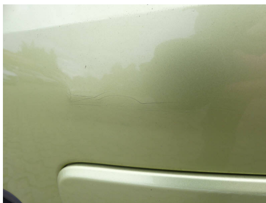
Bild 22: Karosserie / Stoßfänger vorne Kratzer+gerissen
