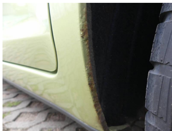
Bild 52: Karosserie / Fondseite links Korrosion
