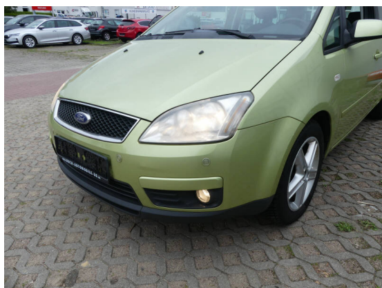
Bild 21: Karosserie / Stoßfänger vorne Kratzer+gerissen
