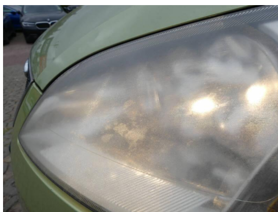
Bild 18: Technik / Scheinwerfer vorne matt/milchig
