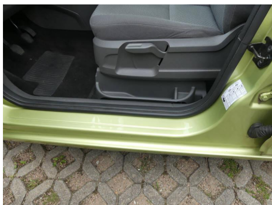
Bild 9: Karosserie / Einstieg vorne links Kratzer
