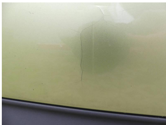
Bild 49: Karosserie / Stoßfänger hinten Kratzer+gerissen
