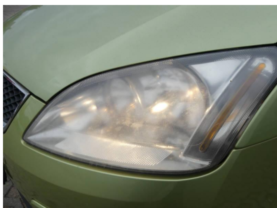
Bild 17: Technik / Scheinwerfer vorne matt/milchig
