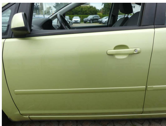
Bild 6: Karosserie / Tür vorne links Kratzer
