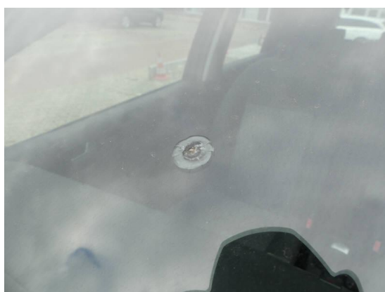
Bild 16: Karosserie / Frontscheibe Steinschlag
