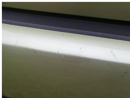
Bild 50: Karosserie / Stoßfänger hinten Kratzer+gerissen
