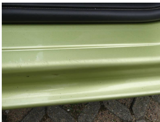
Bild 10: Karosserie / Einstieg vorne links Kratzer
