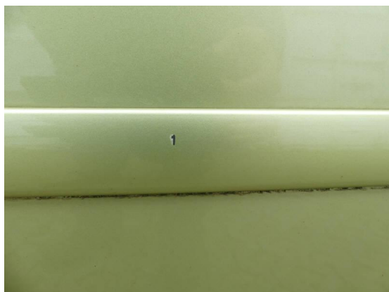
Bild 7: Karosserie / Tür vorne links Kratzer
