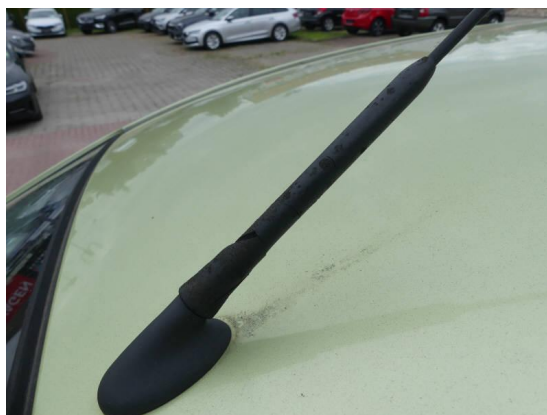
Bild 14: Technik / Antenne beschädigt
