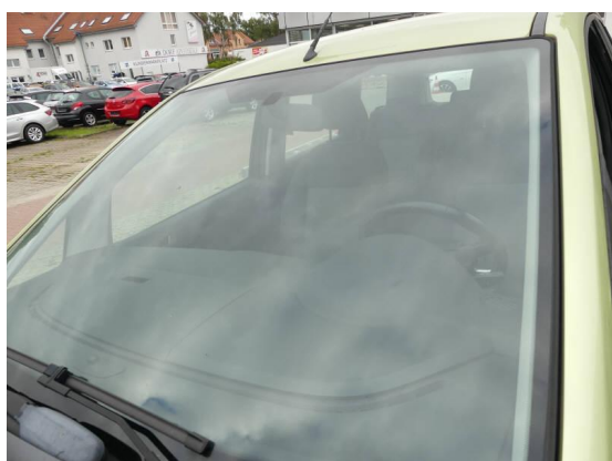
Bild 15: Karosserie / Frontscheibe Steinschlag
