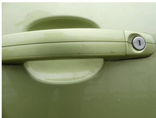
Bild 8: Karosserie / Tür vorne links Kratzer
