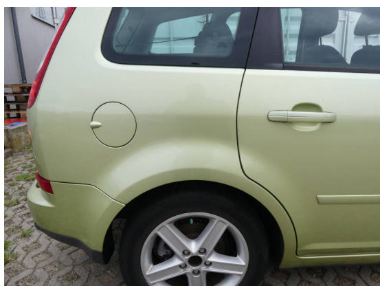
Bild 35: Karosserie / Fondseite rechts Kratzer
