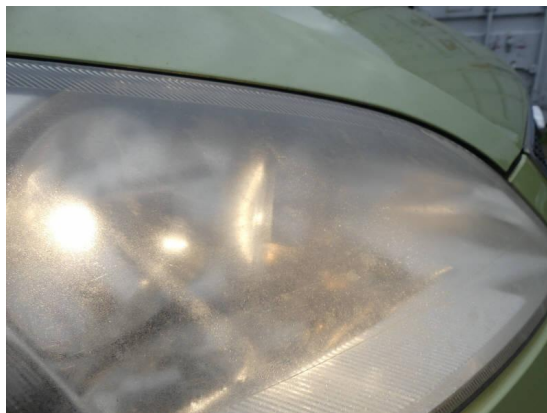
Bild 20: Technik / Scheinwerfer vorne matt/milchig
