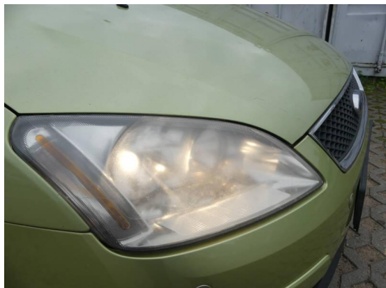
Bild 19: Technik / Scheinwerfer vorne matt/milchig
