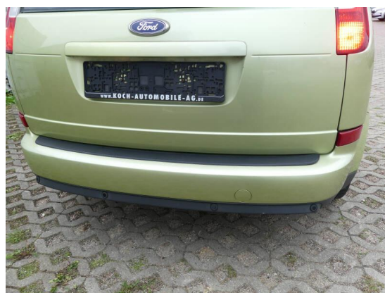
Bild 48: Karosserie / Stoßfänger hinten Kratzer+gerissen
