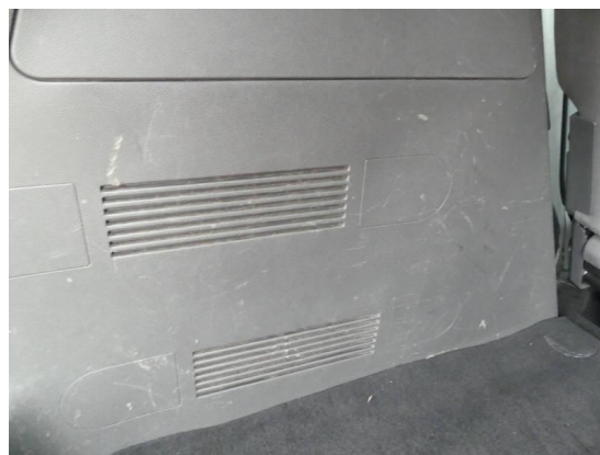
Bild 44: Innenraum / Kofferraumverkleidung Kratzer
