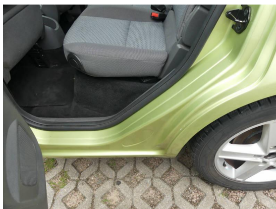
Bild 4: Karosserie / Türdichtung hinten links gerissen
