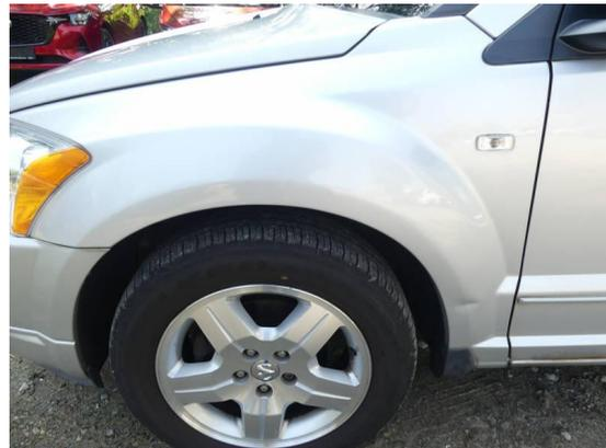
Bild 4: Karosserie / Kotflügel vorne links Dellen
