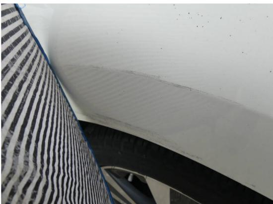
Bild 17: Karosserie / Seitenteil links deformiert und zerkratzt
