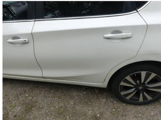
Bild 16: Karosserie / Tür hinten links deformiert und zerkratzt
