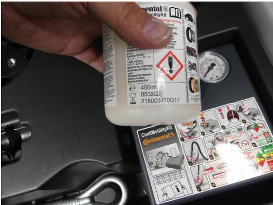
Bild 21: Reifen - Felge / Reifendichtmittel abgelaufen
