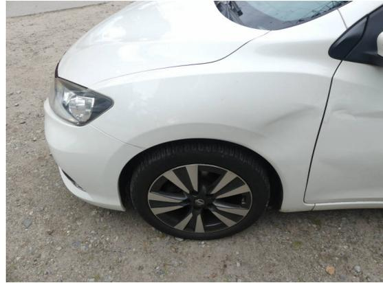
Bild 8: Karosserie / Kotflügel links deformiert und zerkratzt
