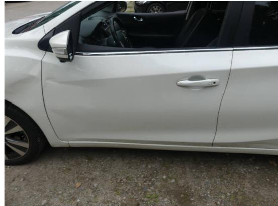
Bild 14: Karosserie / Tür vorne links deformiert und zerkratzt
