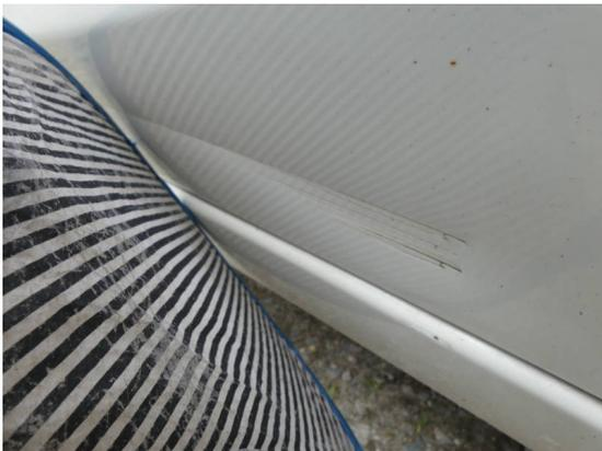
Bild 15: Karosserie / Tür hinten links deformiert und zerkratzt
