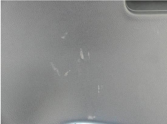
Bild 1: Innenraum / Heckklappenverkleidung Kratzer
