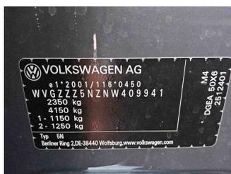
Fahrzeug - Typenschild/Fahrgestellnummer
