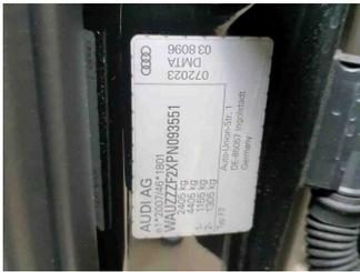
Fahrzeug - Typenschild/Fahrgestellnummer
