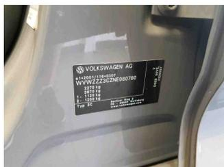
Fahrzeug - Typenschild/Fahrgestellnummer
