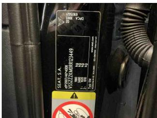
Fahrzeug - Typenschild/Fahrgestellnummer
