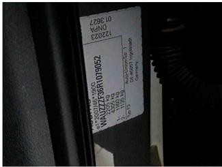
Fahrzeug - Typenschild/Fahrgestellnummer
