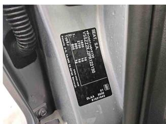
Fahrzeug - Typenschild/Fahrgestellnummer
