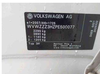
Fahrzeug - Typenschild/Fahrgestellnummer
