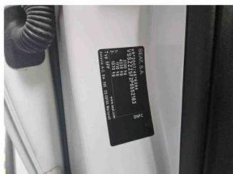
Fahrzeug - Typenschild/Fahrgestellnummer
