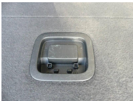
Bild 45: Innenraum / Ladebodenabdeckung Griff gebrochen
