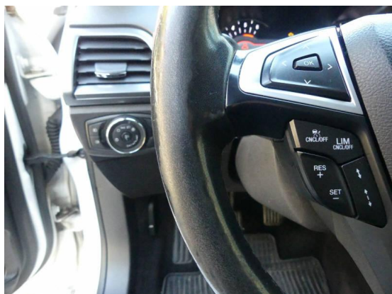
Bild 37: Innenraum / Lenkrad abgenutzt
