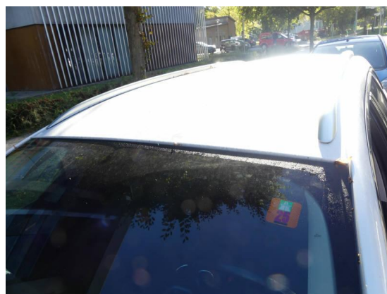
Bild 10: Karosserie / Dach Kratzer/Steinschläge
