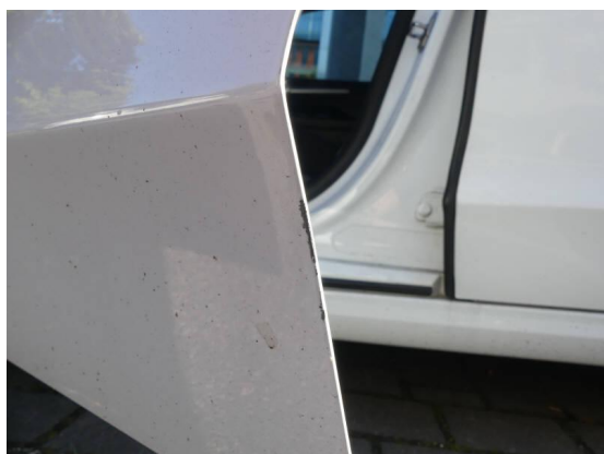
Bild 3: Karosserie / Tür vorne links Kratzer + leicht deformiert
