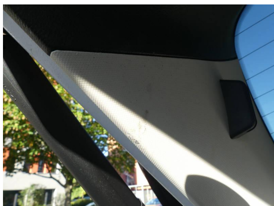
Bild 51: Innenraum / Hackklappenverkleidung Kratzer/beschädigt
