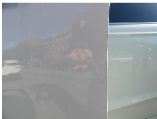
Bild 4: Karosserie / Tür vorne links Kratzer + leicht deformiert
