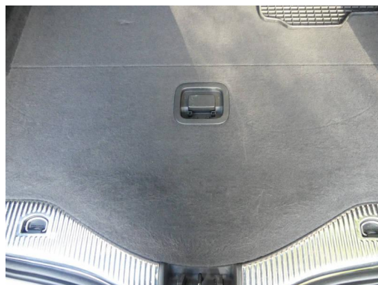
Bild 44: Innenraum / Ladebodenabdeckung Griff gebrochen
