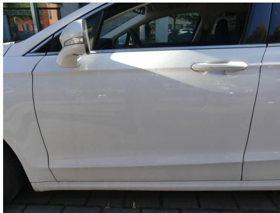
Bild 2: Karosserie / Tür vorne links Kratzer + leicht deformiert
