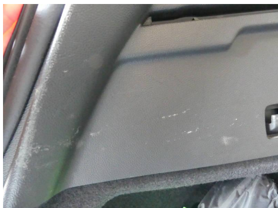
Bild 49: Innenraum / Kofferraumverkleidung Kratzer
