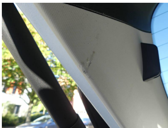
Bild 52: Innenraum / Hackklappenverkleidung Kratzer/beschädigt
