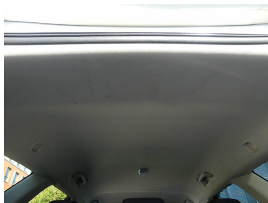
Bild 46: Innenraum / Dachhimmel verschmutzt
