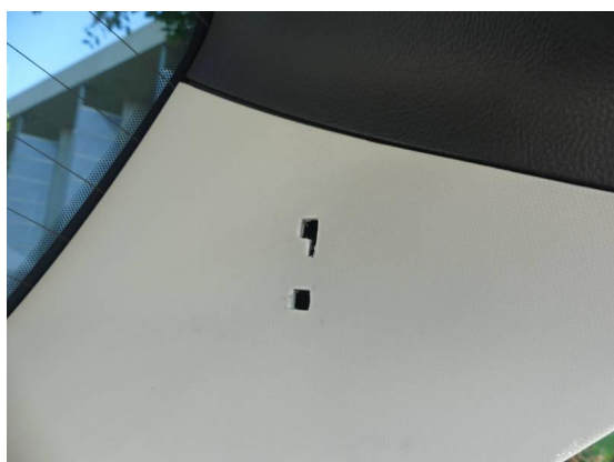
Bild 53: Innenraum / Hackklappenverkleidung Kratzer/beschädigt
