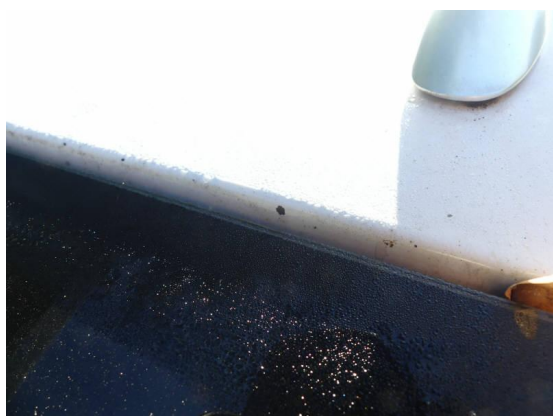
Bild 11: Karosserie / Dach Kratzer/Steinschläge
