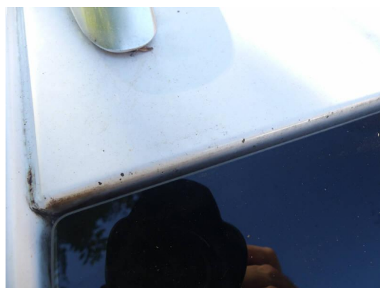
Bild 12: Karosserie / Dach Kratzer/Steinschläge
