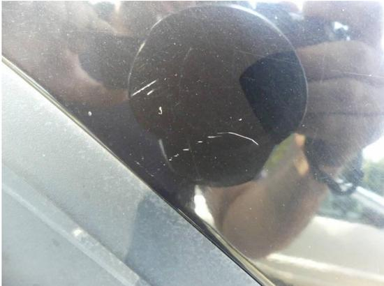
Bild 43: Karosserie / Dach Kratzer+Dellen
