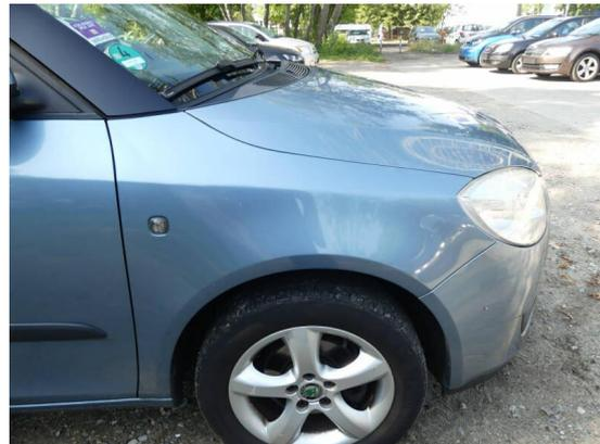
Bild 4: Karosserie / Kotflügel vorne rechts Kratzer
