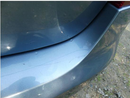
Bild 27: Karosserie / Stoßfänger hinten Kratzer
