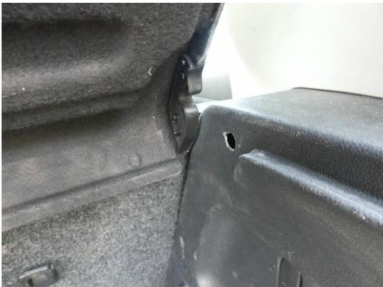
Bild 35: Innenraum / Kofferraumverkleidung Kratzer + Aufnahme Hutablage gebrochen
