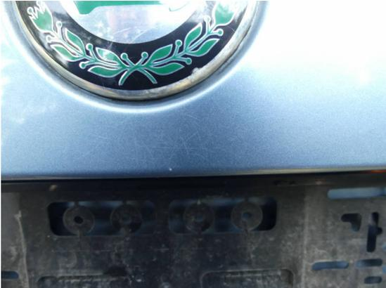
Bild 25: Karosserie / Heckklappe Kratzer
