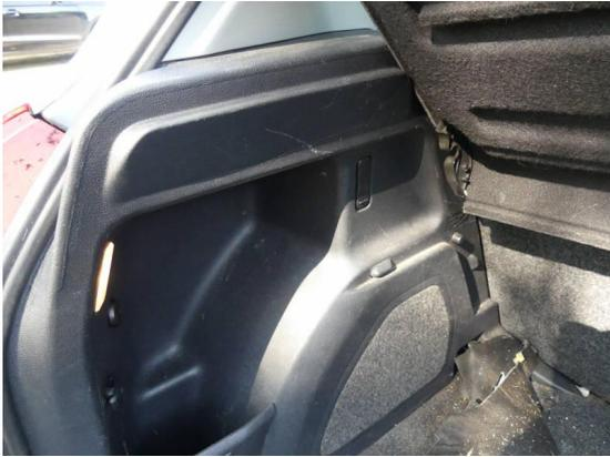
Bild 37: Innenraum / Kofferraumverkleidung Kratzer + Aufnahme Hutablage gebrochen
