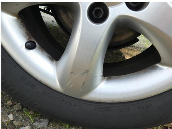
Bild 59: Reifen - Felge / 2x Felgen Kratzer
