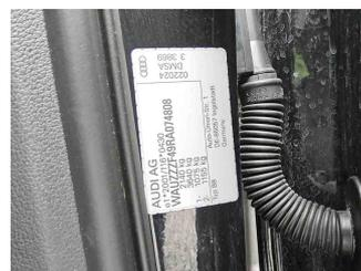
Fahrzeug - Typenschild/Fahrgestellnummer
