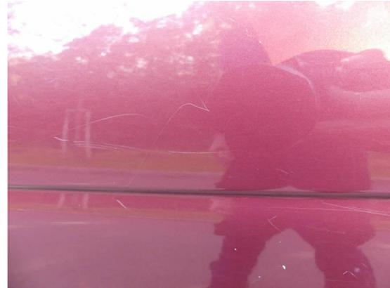
Bild 50: Karosserie / Tür hinten links Kratzer
