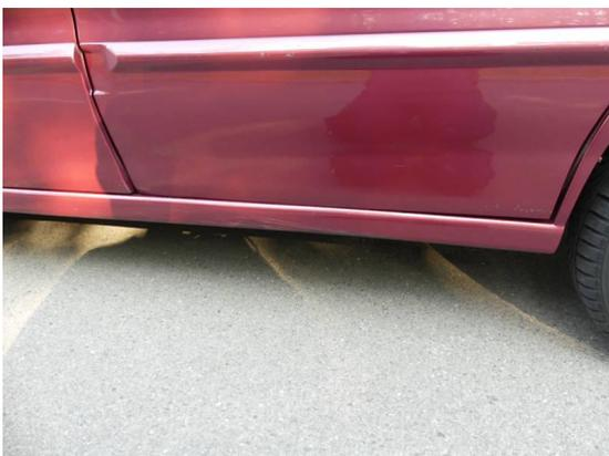
Bild 41: Karosserie / Schweller - Einstieg links Kratzer
