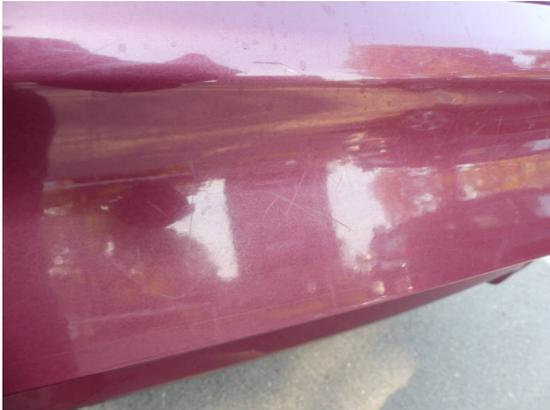
Bild 37: Karosserie / Heckklappe Kratzer
