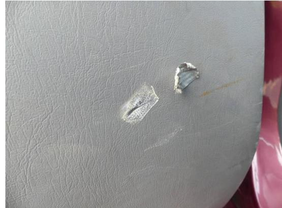
Bild 44: Innenraum / Türverkleidung hinten links Loch
