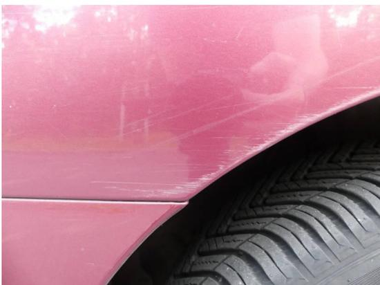
Bild 59: Karosserie / Kotflügel vorne links Kratzer
