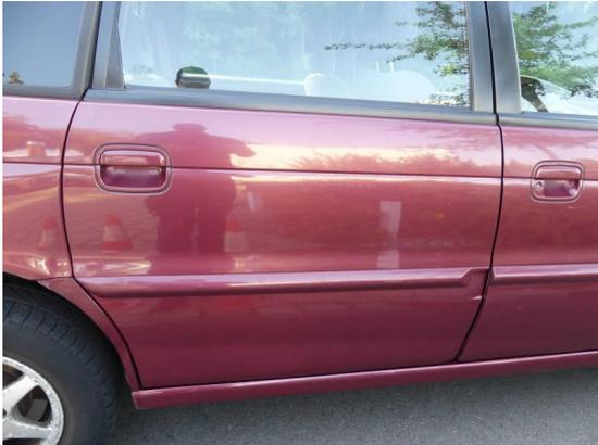
Bild 19: Karosserie / Tür hinten rechts Kratzer
