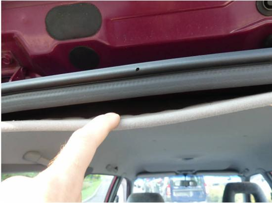
Bild 31: Innenraum / Dachhimmel lose/hängt runter
