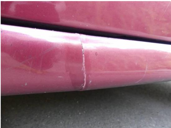
Bild 15: Karosserie / Schweller rechts gebrochen
