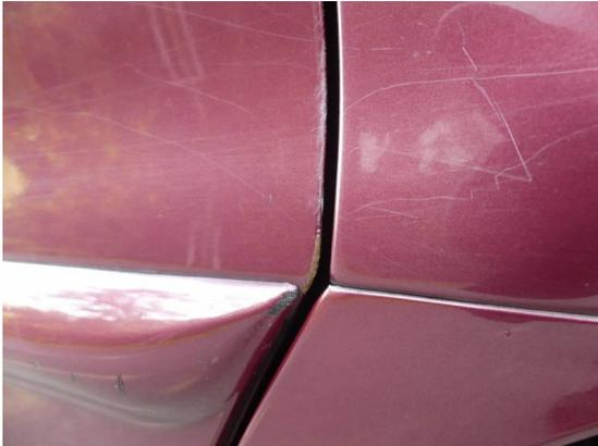
Bild 49: Karosserie / Tür hinten links Kratzer
