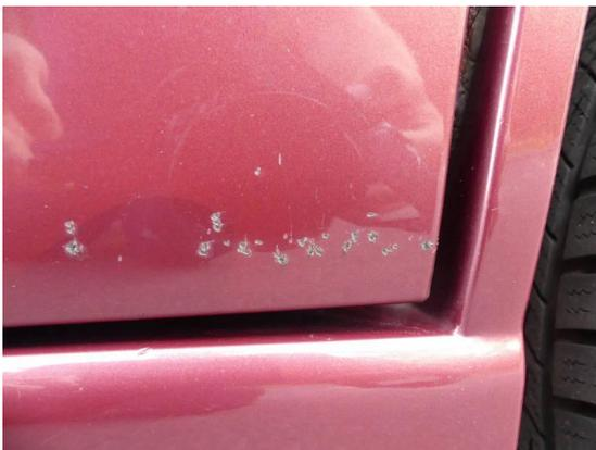
Bild 51: Karosserie / Tür hinten links Kratzer
