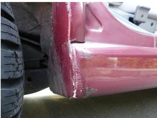
Bild 17: Karosserie / Schweller rechts gebrochen
