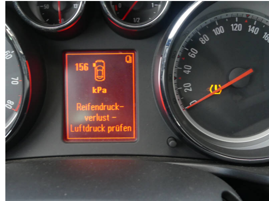
Bild 14: Technik / RDKS-Leuchte leuchtet (Reifendruck vorne links)
