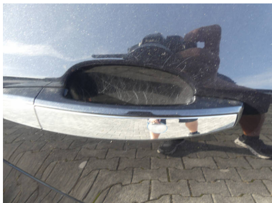
Bild 5: Karosserie / Tür hinten rechts zerkratzt
