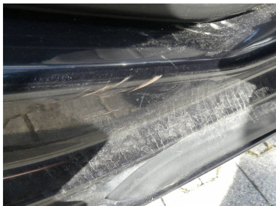
Bild 3: Karosserie / Einstieg hinten rechts zerkratzt
