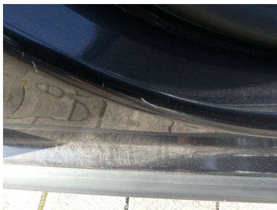
Bild 8: Karosserie / Einstieg vorne rechts zerkratzt
