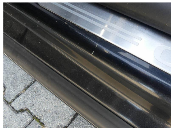
Bild 18: Karosserie / Einstieg vorne links zerkratzt
