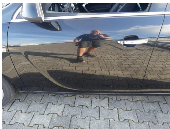
Bild 22: Karosserie / Tür vorne links zerkratzt
