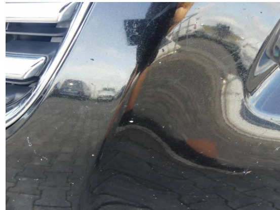
Bild 16: Karosserie / Stoßfänger vorn zerkratzt und Steinschläge
