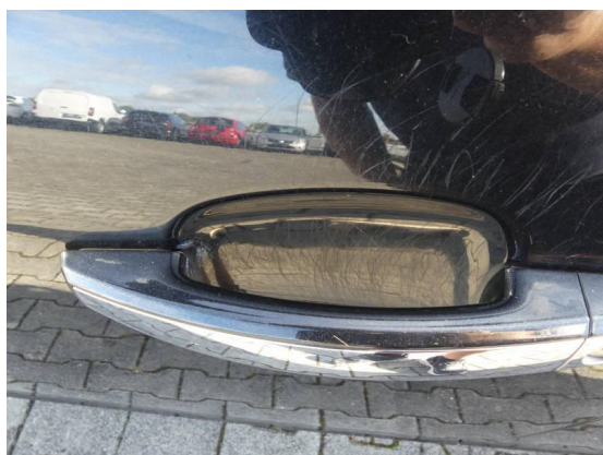
Bild 21: Karosserie / Tür vorne links zerkratzt
