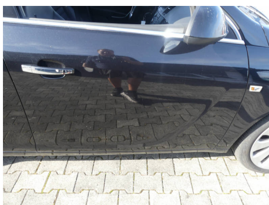
Bild 12: Karosserie / Tür vorne rechts zerkratzt
