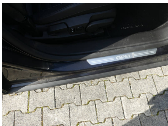
Bild 9: Karosserie / Einstieg vorne rechts zerkratzt
