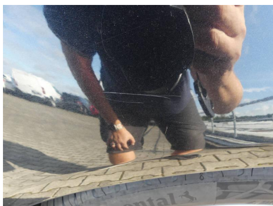
Bild 29: Karosserie / Seitenteil links zerkratzt
