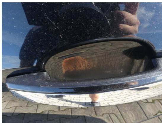
Bild 26: Karosserie / Tür hinten links zerkratzt
