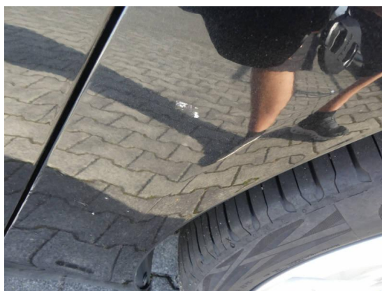
Bild 28: Karosserie / Seitenteil links zerkratzt
