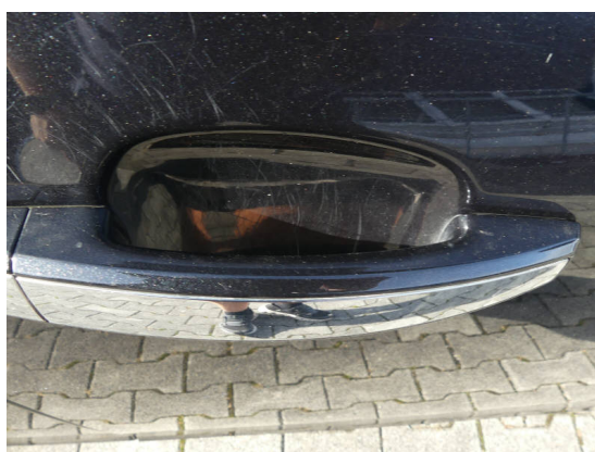
Bild 10: Karosserie / Tür vorne rechts zerkratzt
