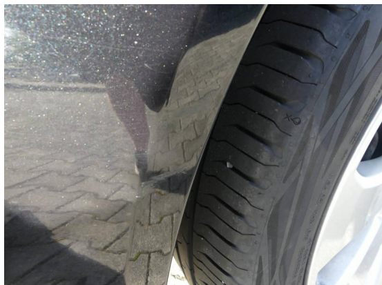
Bild 31: Karosserie / Stoßfänger hinten rechts Kratzer
