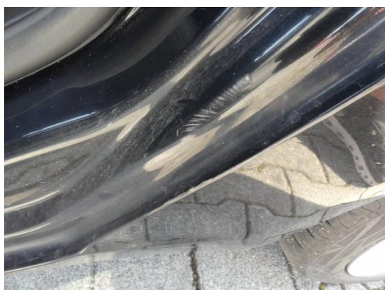
Bild 23: Karosserie / Einstieg hinten links zerkratzt
