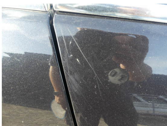
Bild 11: Karosserie / Tür vorne rechts zerkratzt
