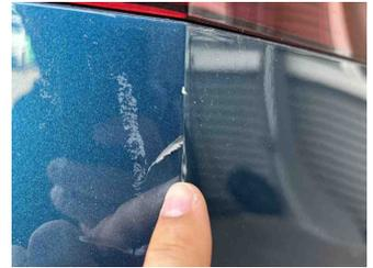
2 - Tür vorne links - Delle(n) und Kratzer - Instandsetzen + lackieren (teilweise)
