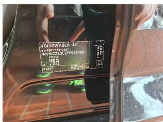
Fahrzeug - Typenschild/Fahrgestellnummer
