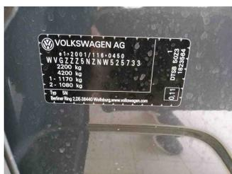
Fahrzeug - Typenschild/Fahrgestellnummer
