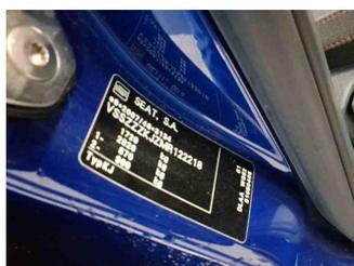
Fahrzeug - Typenschild/Fahrgestellnummer
