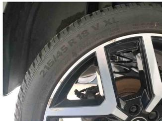
5 - Alufelge glanzgedreht hinten links - Kratzer - Optische Wertminderung
