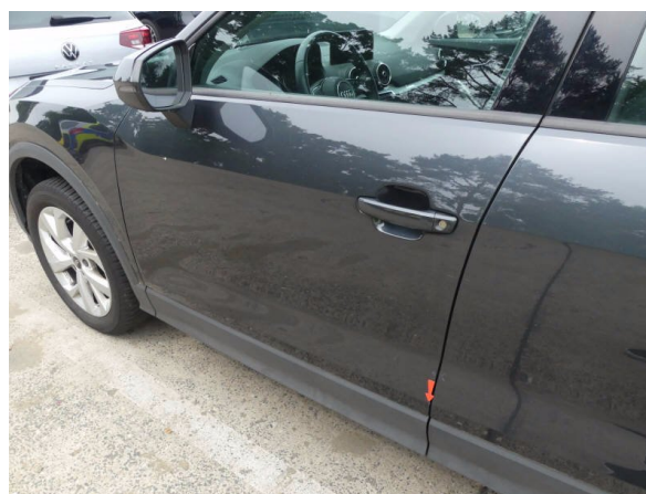
Bild 16: Türkante Abplatzungen - ohne Reparatur
