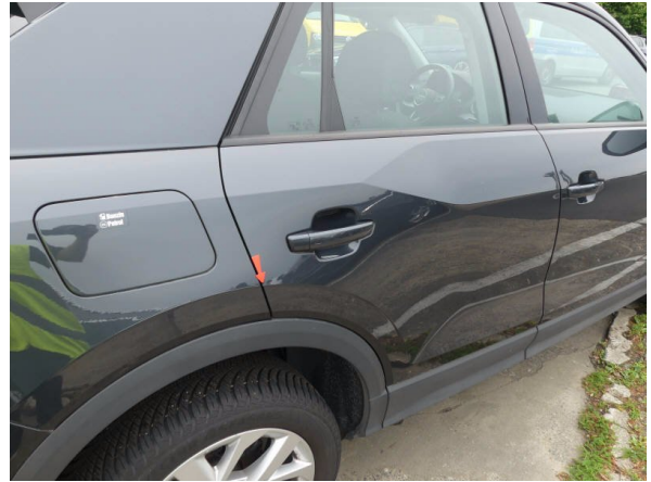
Bild 20: Türkante Abplatzungen - ohne Reparatur
