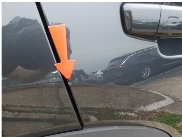
Bild 21: Türkante Abplatzungen - ohne Reparatur
