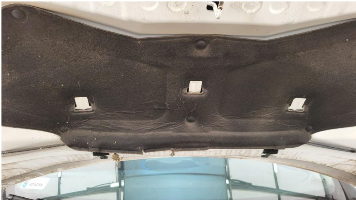
Fot. 32 Wykładzina pokrywy komory silnika - Pęknięcie/rozerwanie 1
