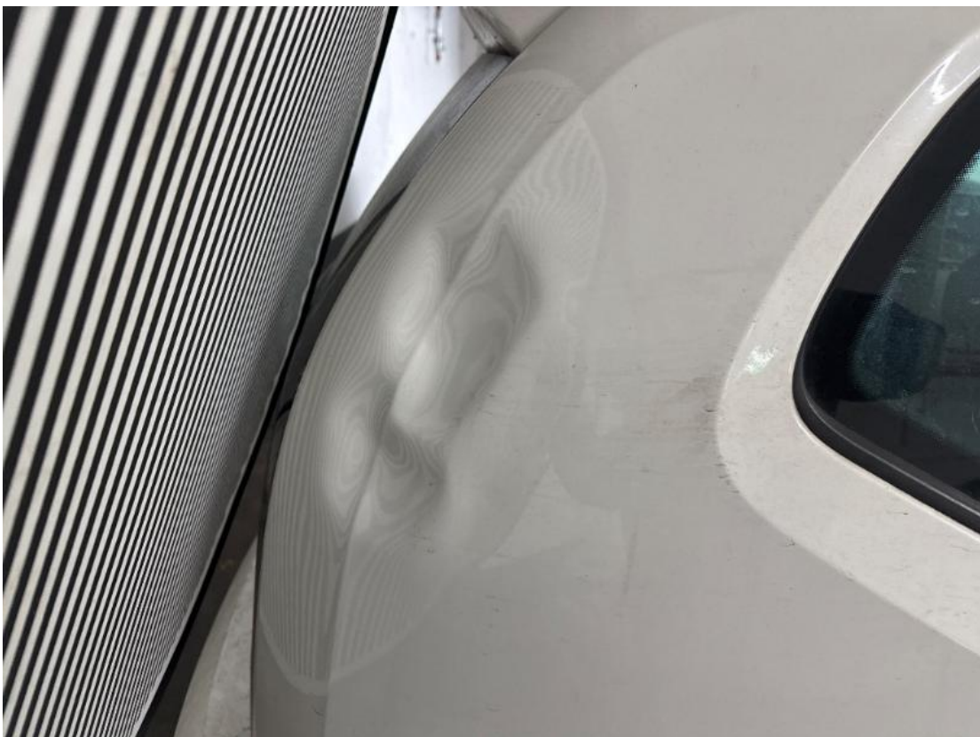
5. Seitenwand hinten rechts - Dellen
