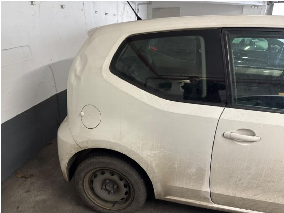
5. Seitenwand hinten rechts - Dellen
