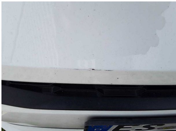
Beschädigung #7: Stossfänger vorn: Stossfänger vorn - verkratzt / verschürft - Smart Repair
