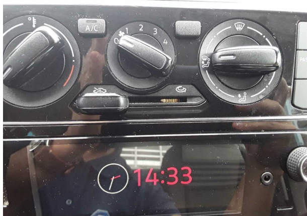
Beschädigung #1: Instrumententafel: Mittelkonsole vorn (Münze im Spalt) - ohne Funktion - entfernen
