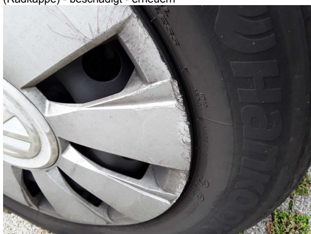
Beschädigung #3: Rad/Reifen: Leichtmetallfelge vorn rechts (Radkappe) - beschädigt - erneuern
