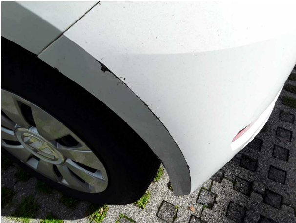
Beschädigung #13: Stossfänger hinten: Stossfänger hinten - verformt - erneuern
