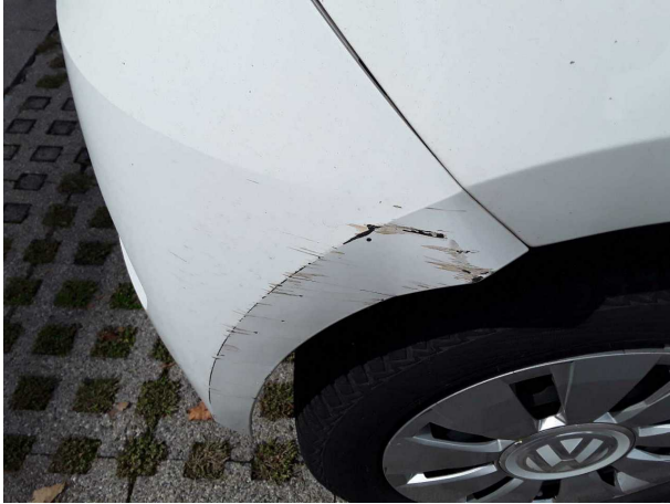
Beschädigung #13: Stossfänger hinten: Stossfänger hinten - verformt - erneuern
