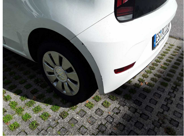
Beschädigung #13: Stossfänger hinten: Stossfänger hinten - verformt - erneuern
