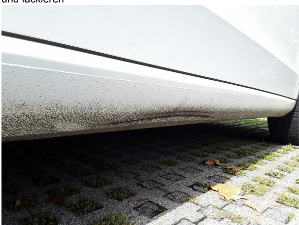
Beschädigung #12: Schweller rechts: Schweller - verformt - instandsetzen und lackieren
