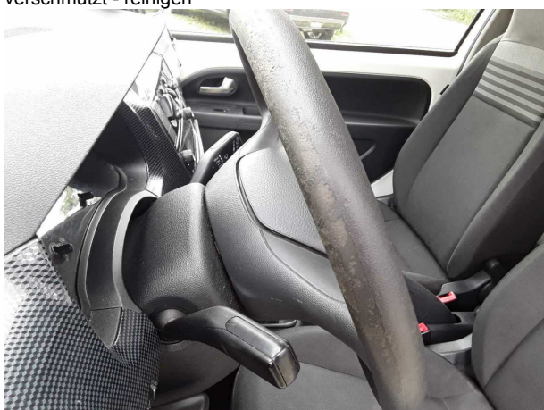
Beschädigung #6: Lenkanlage: Lenkrad - gebrochen / gerissen - Wertminderung
