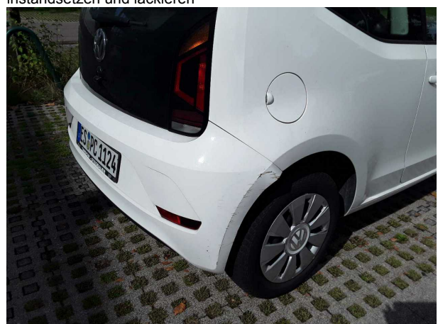
Beschädigung #13: Stossfänger hinten: Stossfänger hinten - verformt - erneuern
