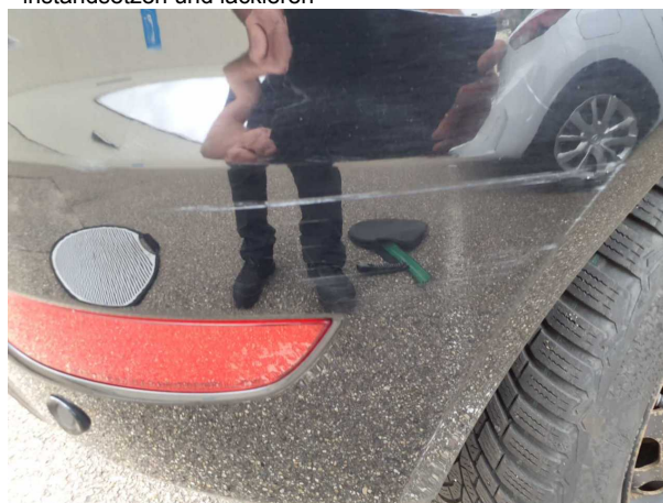
Beschädigung #12: Stossfänger hinten: Stossfänger hinten - beschädigt - erneuern
