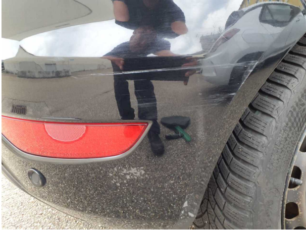
Beschädigung #12: Stossfänger hinten: Stossfänger hinten - beschädigt - erneuern
