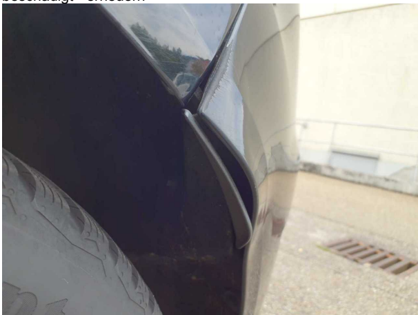
Beschädigung #12: Stossfänger hinten: Stossfänger hinten - beschädigt - erneuern
