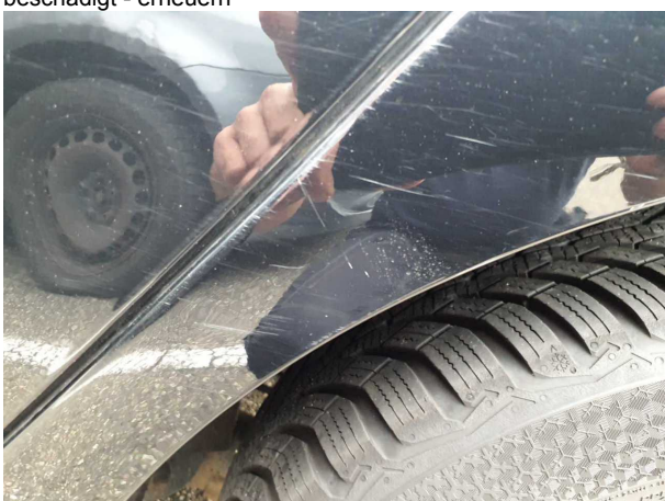
Beschädigung #13: Seitenwand links: Seitenwand - Kratzer - lackieren
