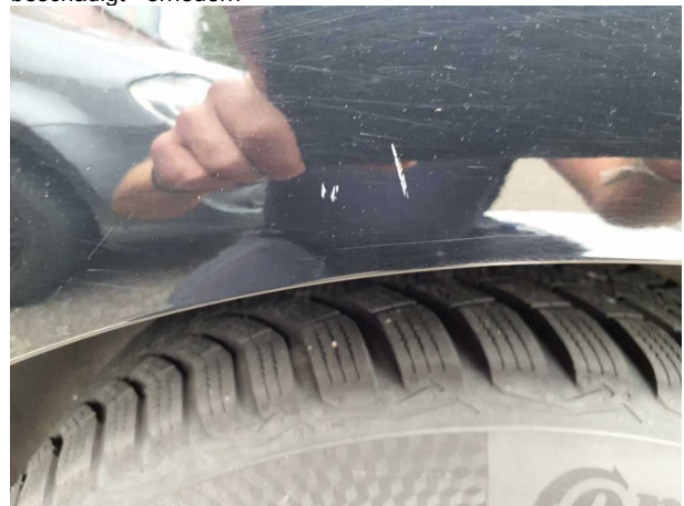
Beschädigung #13: Seitenwand links: Seitenwand - Kratzer - lackieren
