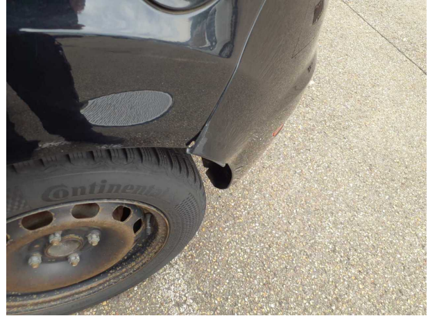
Beschädigung #12: Stossfänger hinten: Stossfänger hinten - beschädigt - erneuern
