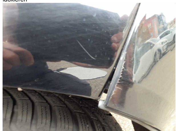
Beschädigung #13: Seitenwand links: Seitenwand - Kratzer - lackieren
