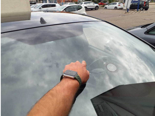
Beschädigung #8: Verglasung: Frontscheibe - beschädigt - erneuern
