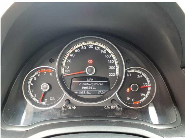
Abbildung 5: Kombiinstrument
