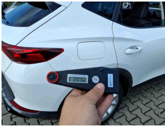
Lackstärke Seitenwand hinten rechts
