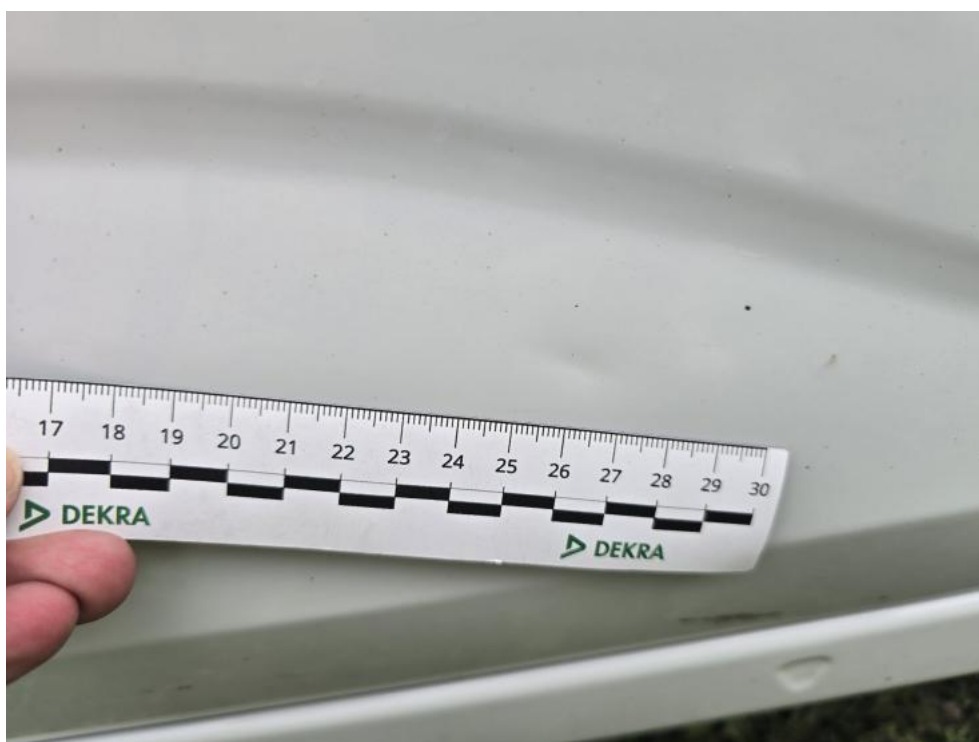
Fot. 42. Drzwi przednie P - Wgniecenie/odkształcenie 1
