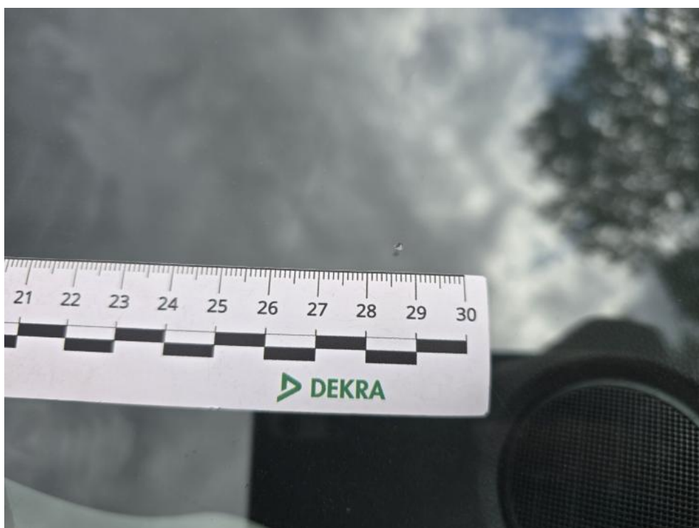
Fot. 40. Szyba czołowa - Rysa/odprysk 1
