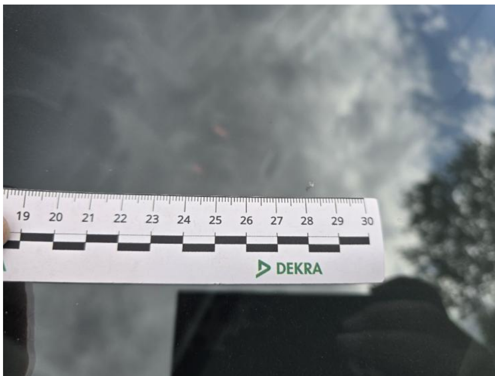
Fot. 41. Szyba czołowa() - Rysa/odprysk 3
