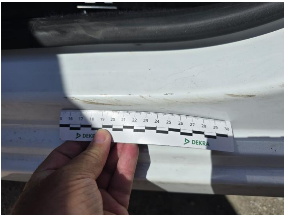
Fot. 45. Próg L - Rysa/odprysk 1
