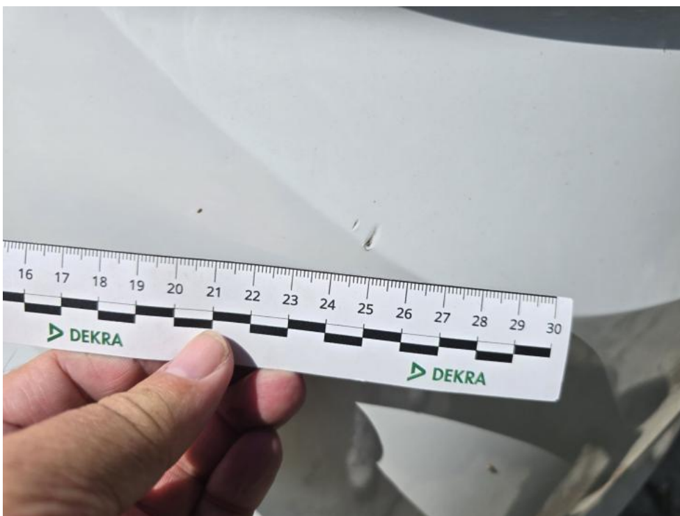
Fot. 42. Zderzak tylny - Pęknięcie/rozerwanie 2
