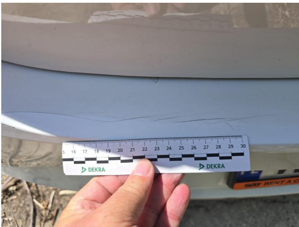
Fot. 41. Zderzak tylny - Pęknięcie/rozerwanie 1
