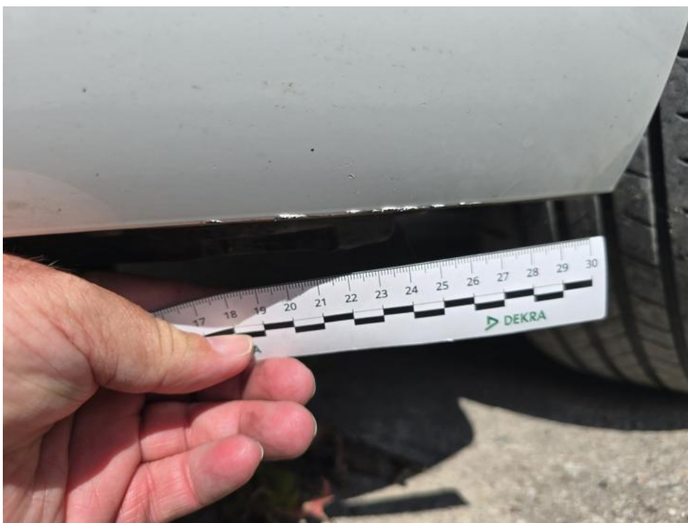
Fot. 40. Zderzak - Rysa/odprysk 1
